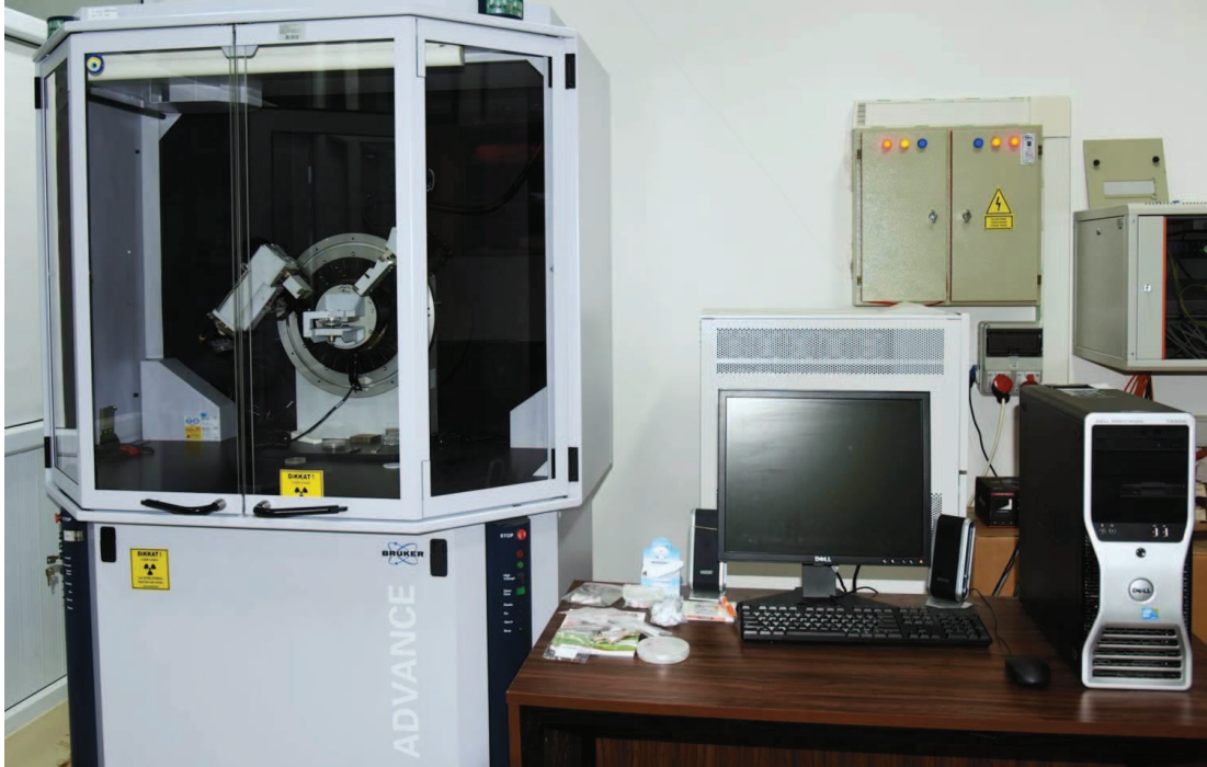
Şekil 2.4. Bruker' in X-ışını Kırınımı D8- Advance cihazı (Kastamonu Üniversitesi Merkezi Araştırma Laboratuvarı)
