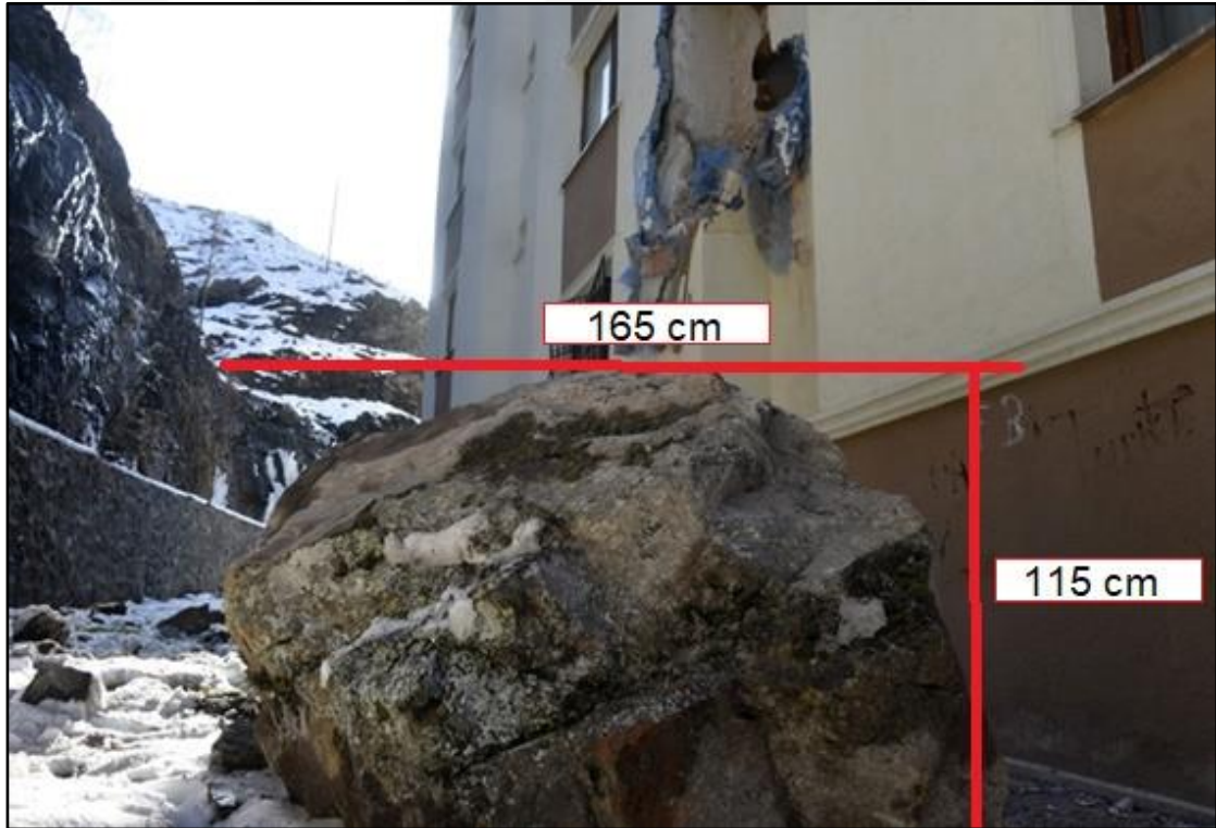
Şekil 3.9. Alibaba Formasyonu'na ait kaynak kaya alanlarından kopan andezit blokları (Oltanbey Mah. Müze Evler Sitesi)
