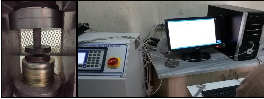
Şekil 3.22. Birimlere ait örnekler ve Tek eksenli basınç dayanımı deneyi
