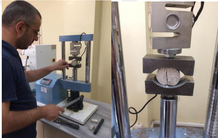
Şekil 3.21. Çekilme dayanımı deneyi (Brazilian Yöntemi)
