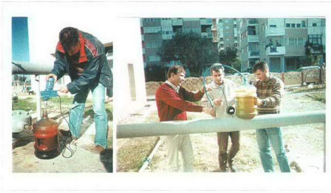
Şekil 4.11 BD-2 (I) Deneyinde İzleyicinin Hazırlanması ve Kuyuya Basılması
