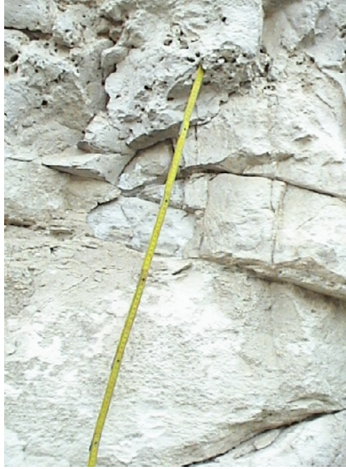
Şekil 2.11 Ölçülü stratigrafik kesit 3'de kesitin alt kısmındaki 3 m kalınlığa sahip, gri renkli, sert, parçalı, tabakalanma gösteren, fosil kırıntıları içeren marnın yakından görünümü. Koordinat: 86080/39343
