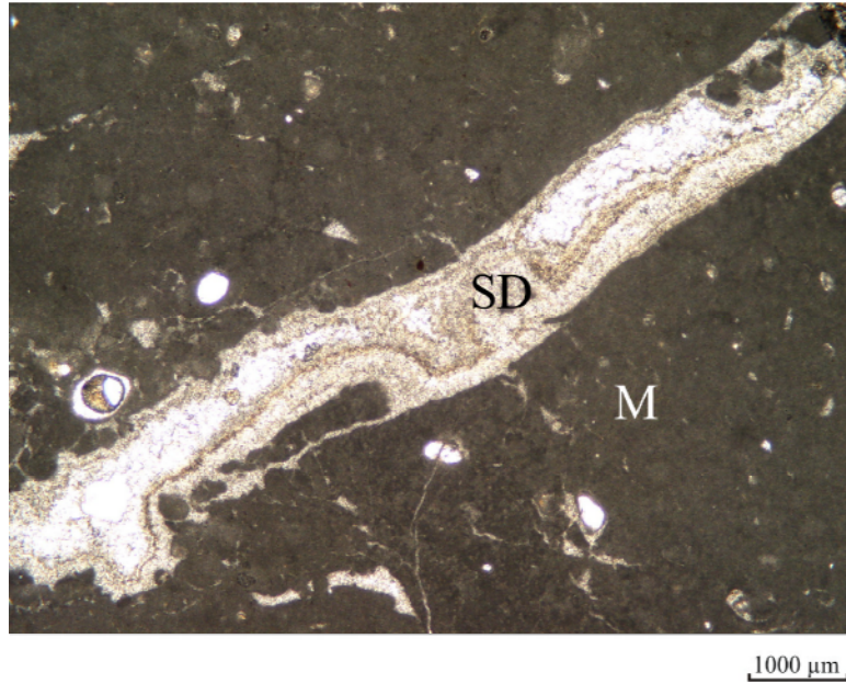
Şekil 3.32 Mikrofasiyes 14, İtraklastlı İstiftaşı / İntrasparit-İntramikrit, SD: Spar kalsit ile doldurulmuş damar, M: Mikrit, Koordinat: 92218/24864 , Örnek no: 10, Spar ile doldurulmuş damarın içinde ortospar kristalleri görülmektedir.
