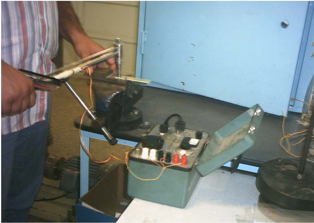
Şekil 4.3 Ön yüklemde kullanılan moment anahtarı ve düzeneęi
