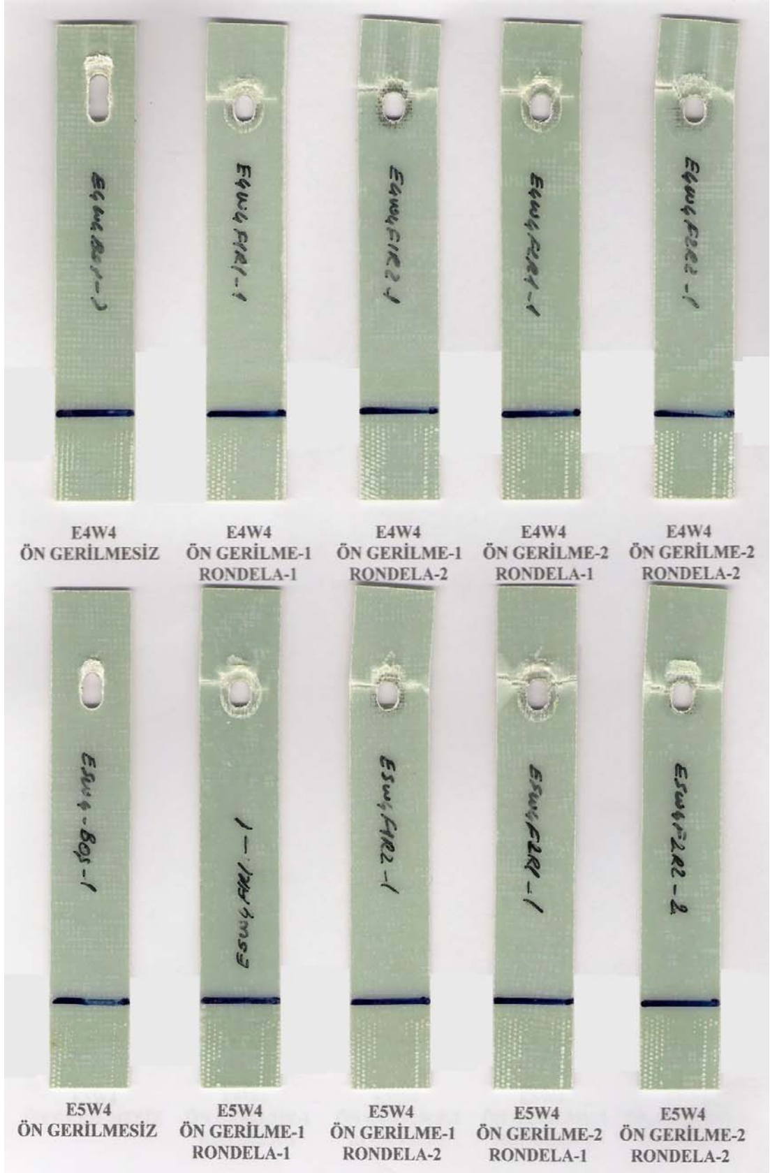
Şekil 5.4 Ön gerilme değişiminin, rondela çapı değişiminin t=1\text{mm} kalınlığındaki E4W4 – E5W4 boyutlu deney numuneleri üzerindeki hasar şeklinin görünüşü.
