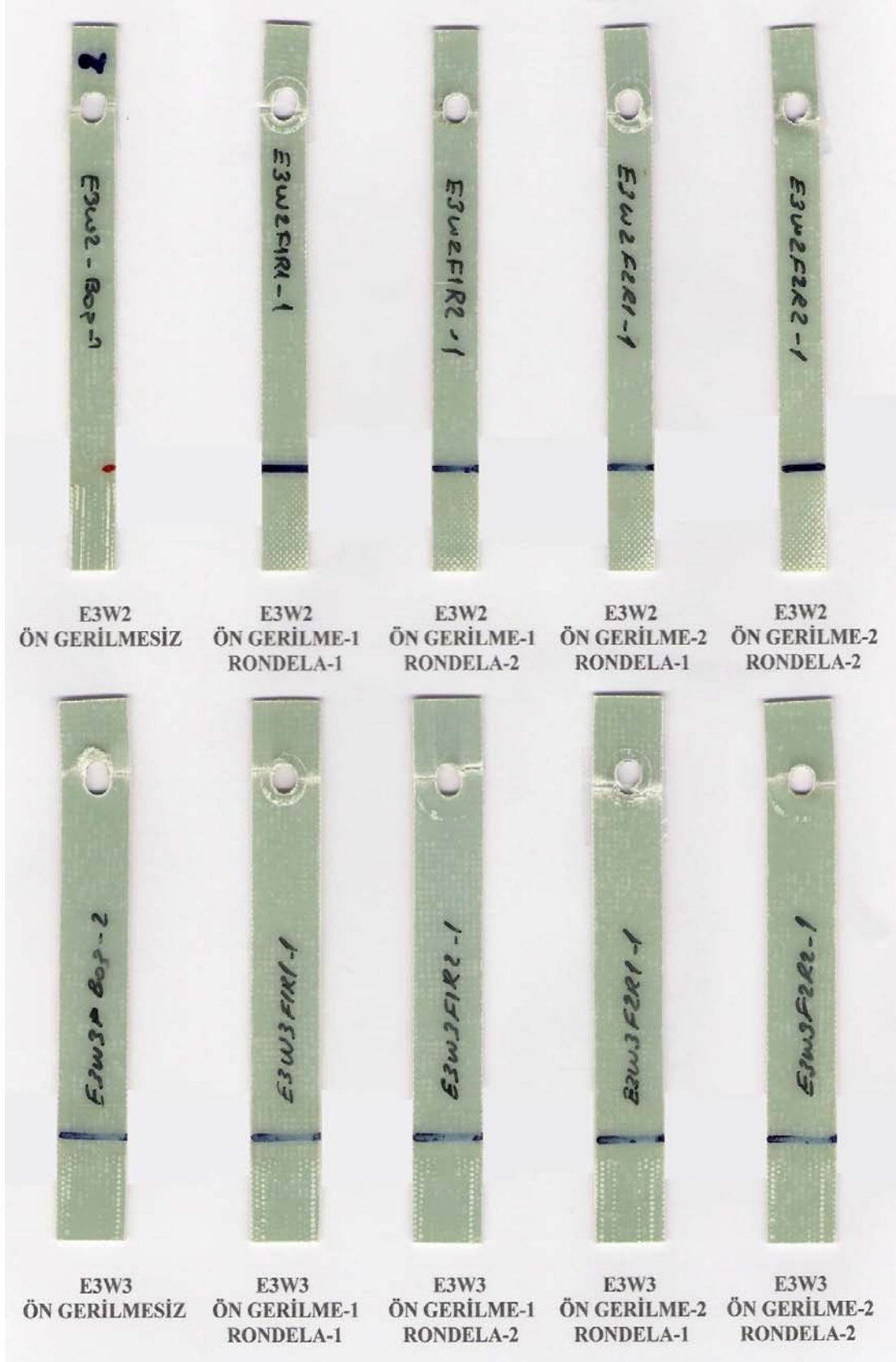
Şekil 5.1 Ön gerilme değişiminin, rondela çapı değişiminin t=1\text{mm} kalınlığındaki E3W2 – E3W3 boyutlu deney numuneleri üzerindeki hasar şeklinin görünüşü.
