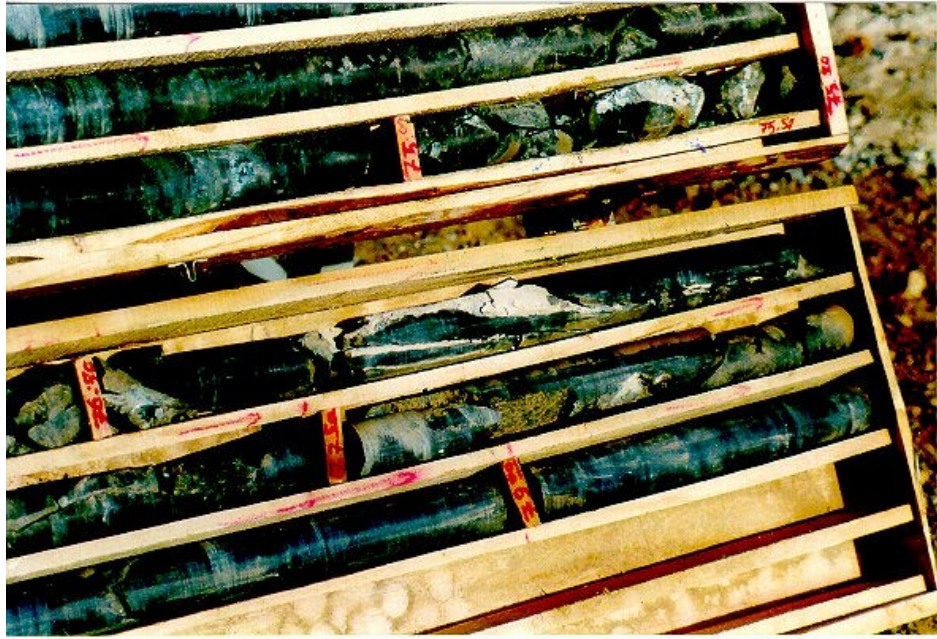
Şekil 4.9 ve 4.10 Kontrol kuyularından alınan karotların (NQ) görünüşleri.
