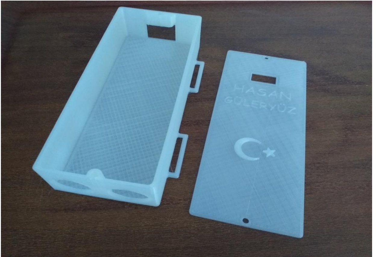
Şekil 49. Engel algılayıcı sensör 3D baskısı.
