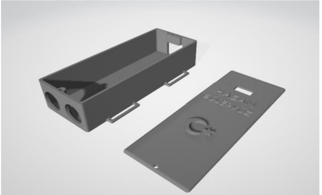
Şekil 47. Engel algılayıcı sensör çizimi için 3D Builder program uygulaması.
