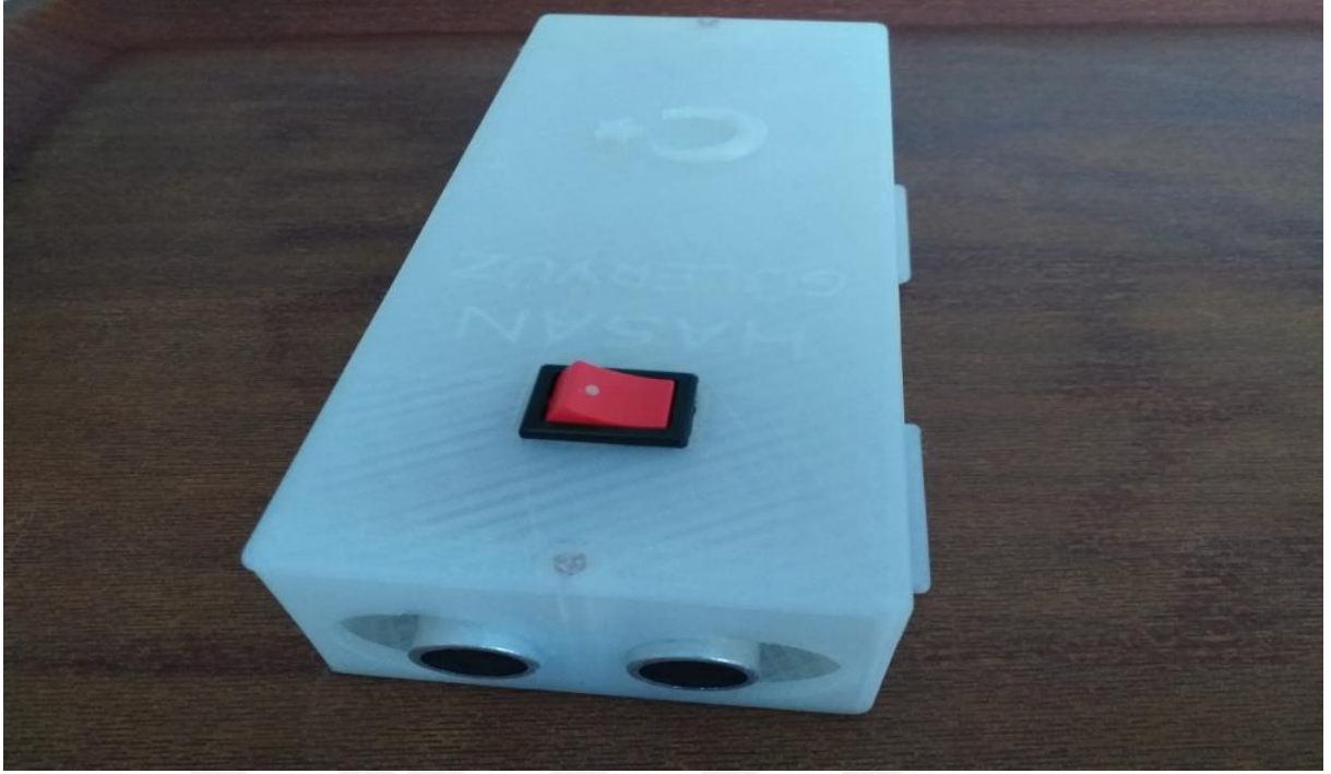
Şekil 58. Görmeengelliler için engel algılayıcı sensör.
