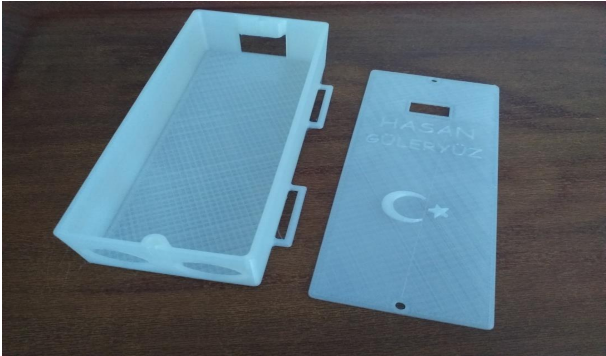
Şekil 57. Engel algılayıcı sensör 3D baskısı.
