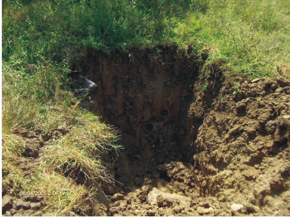
Şekil 5.4 KM 1+400 Kaymasında açılan araştırma çukuru.
