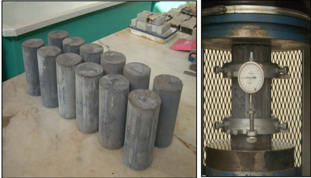
Şekil 4.40 Elastisite modülleri belirlenecek örnekler ve deformasyon çerçevesi
