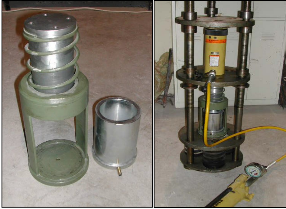
Şekil 4.48 Sıkıştırma için kullanılan özel çelik kalıp ve sıkıştırma mekanizması
