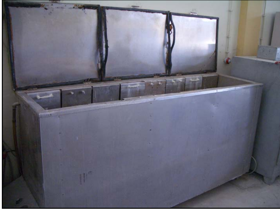
Şekil 4.9 Deneylerde kullanılan buhar kürü cihazı
