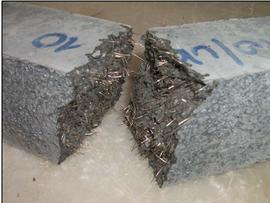
Şekil 4.18 Eğilme deneyi sonrası kırılan örnekteki lif dağılımı
