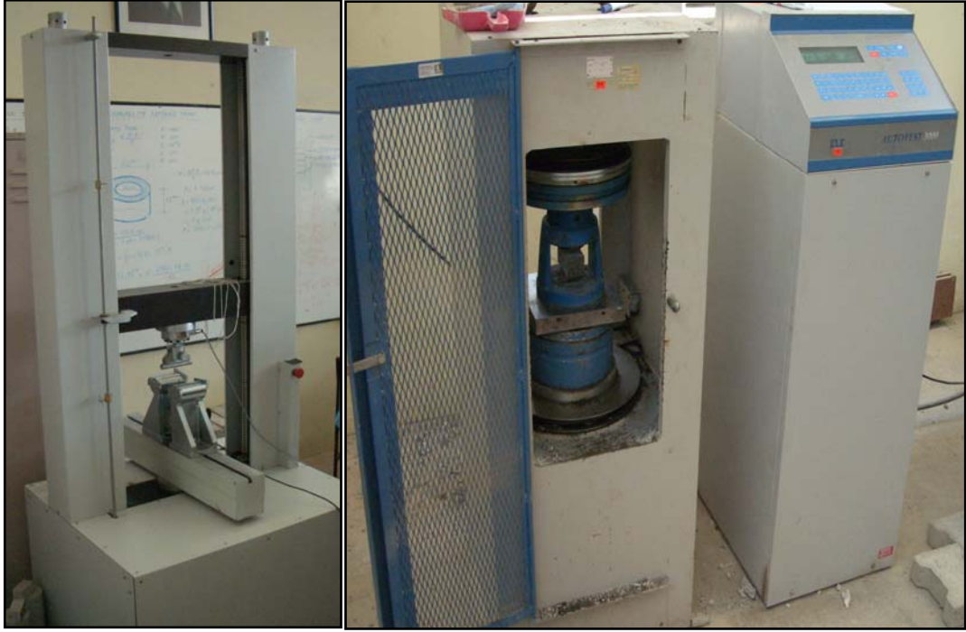
Şekil 4.4 Eğilme ve basınç dayanımı deneylerinde kullanılan araçlar
