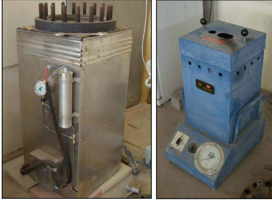
Şekil 4.7 Deneyleerde kullanılan otoklav makineleri
