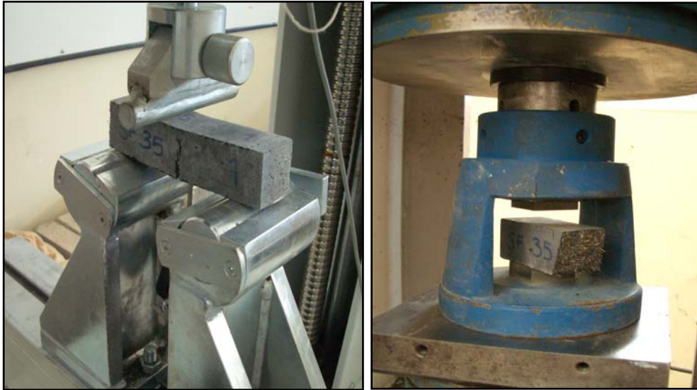
Şekil 4.17 Eğilme deneyi ve eğilme sonrası basınç dayanımı deneyi
