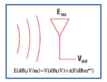
Figure 3.6 Antenna factor parameters
