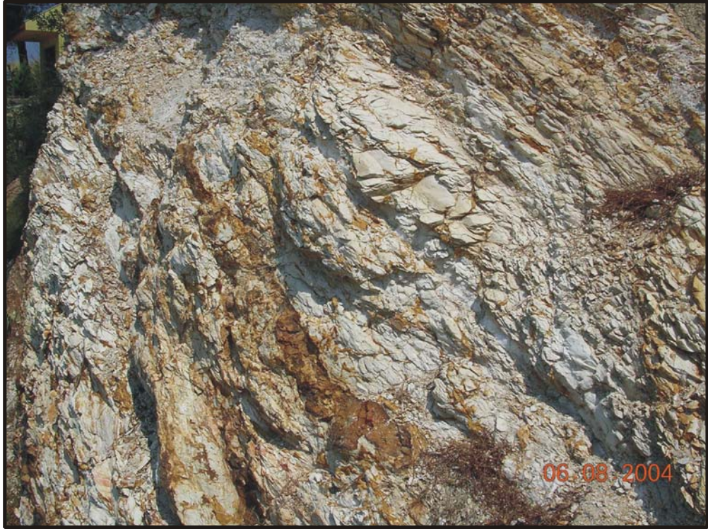
Şekil 5.7 Andezitik tüflerde gözlenen hidrotermal alterasyon ve fiziksel bozunma (Koordinat: 475017/4353900).
