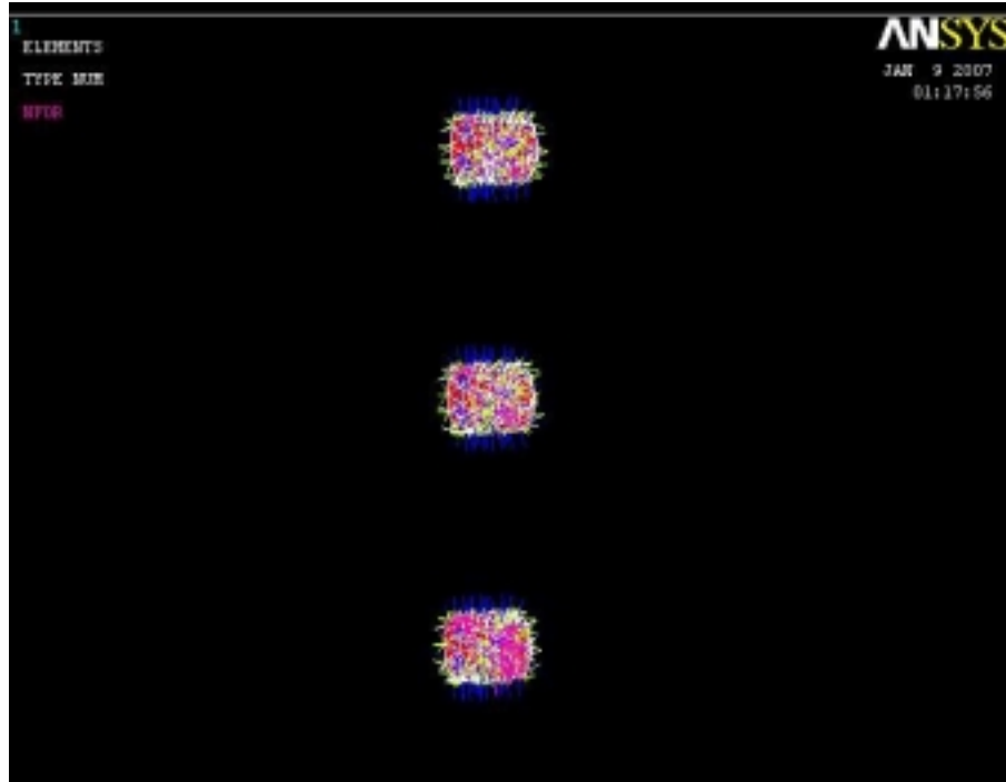
Şekil 3.11 Vidalar ile plak delikleri arasında oluşturulan kontak bölgeleri.
