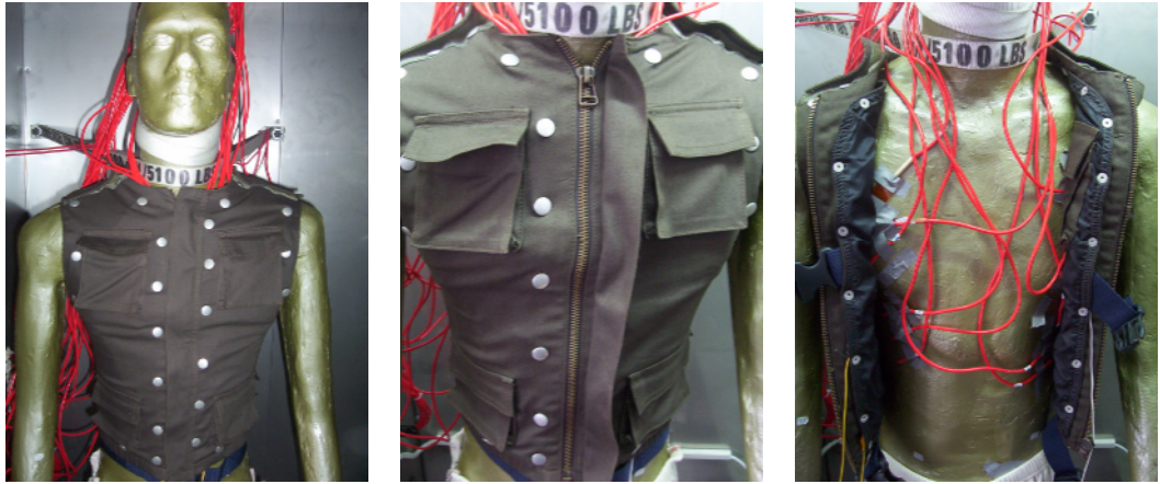
Şekil 4.4 Termal manken üzerine giydirilmiş ısıtıcı giysi prototipi.
