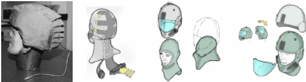
Şekil 1.9 Askeri miğferlerin değişik katmanları. (Stewardson, 2001).
