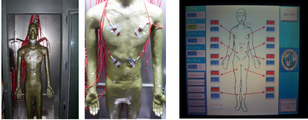
Şekil 3.18 Termal manken ve ölçüm ekranı.
