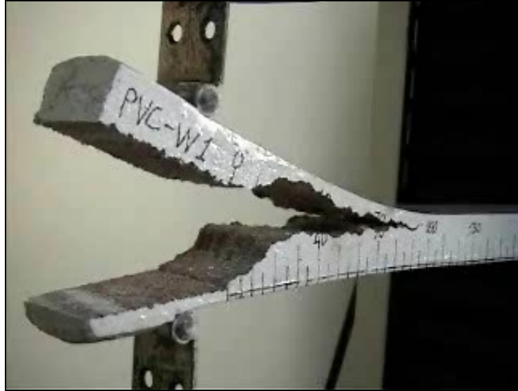
Şekil 3.6 Tuzlu suda bekletilmiş numunenin deneyinden bir görüntü.
