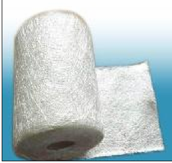
Şekil 2.2 Doğranmış cam liflerden yapılmış keçe elyaf. ( http://drywallmesh.en.alibaba.com/product/50025829/50061616/Fiberglass_Woven_Roving/Chopped_Strand_Mat.html )
