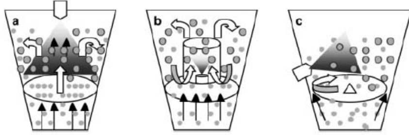
Şekil 1.9 Farklı Tipteki Akışkanlaştırıcı Yataklar (a) yukarıdan püskürtmeli (b) aşağıdan püskürtmeli (c) teğetsel püskürtmeli (Ghosh, 2006)
