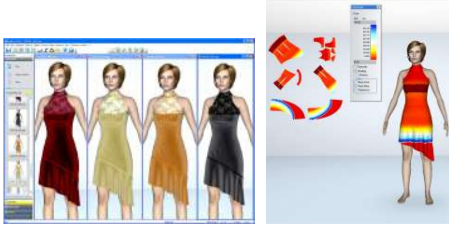
Şekil 1.27 Lectra Modaris 3D Fit programında oluşturulan üç boyutlu giysi görünümü
