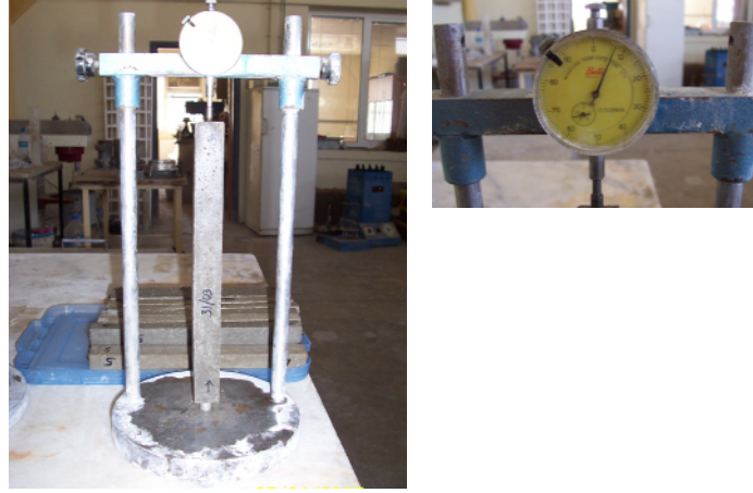
Şekil 4.3 Harç çubuklarının boy ölçümleri için kullanılan komparatör
