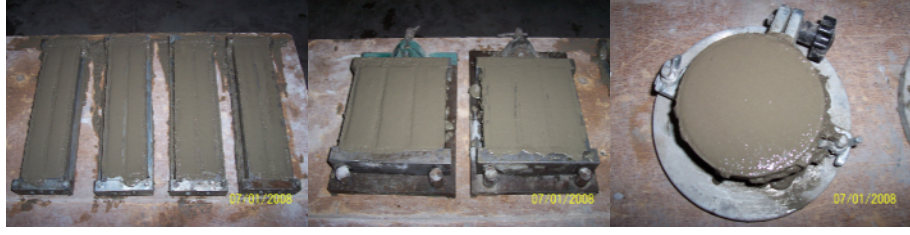
Şekil 4.12 Harcın kalıplara yerleştirilmesi
