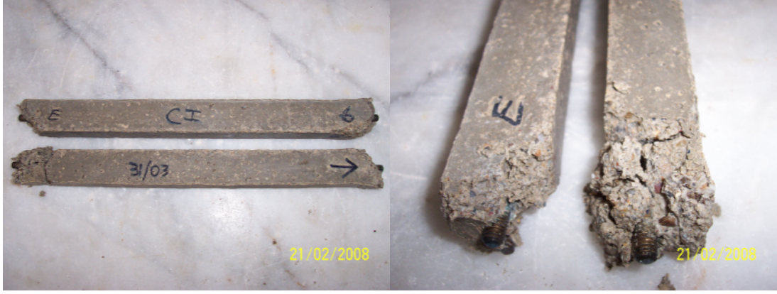
Şekil 5.81 CEM I 42,5 R çimentosuyla hazırlanan harçların 50000 ppm sodyum sülfat çözeltisinde 330. günde uğradığı hasar
