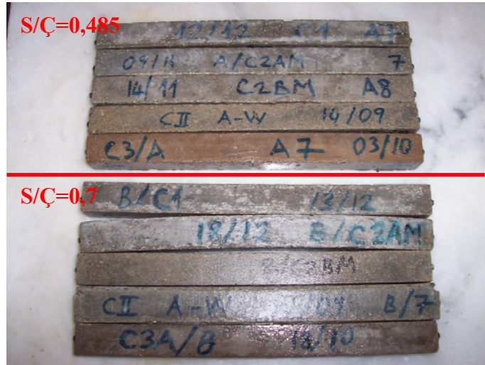
Şekil 5.26 50000 ppm sodyum sülfat çözeltisinde 322. gün. Yukarıdan aşağıya CEM I, CEM II/A-M, CEM II/B-M, CEM II/A-W, CEM III çimentoları.
