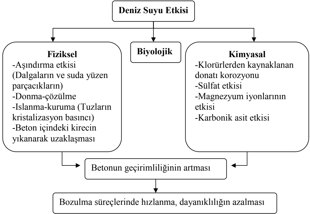
Şekil 2.3 Deniz ortamında bulunan yapıların maruz kalabilecekleri yıpratıcı etkiler (Baradan ve diğer., 2002)
