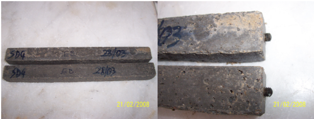
Şekil 5.82 SDÇ 32,5 ile hazırlanan örneklerin 50000 ppm sodyum sülfat çözeltisinde 330 gün bekletildikten sonraki görünüşleri
