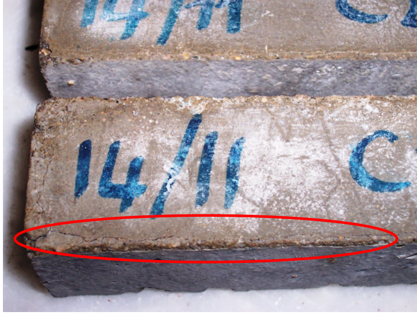
Şekil 5.23 Su/çimento=0,7 olan 40x40x160 mm boyutlu, CEM II/A-M (P-W)42,5R çimentosu içeren prizmatik örneğin 50000 ppm sodyum sülfat çözeltisinde 322. günü
