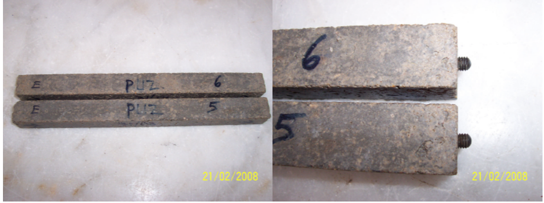
Şekil 5.83 CEM IV/B (P) 32,5 N ile hazırlanan harçların 50000 ppm sodyum sülfat çözeltisinde 330 gün bekletildikten sonraki görünüşleri
