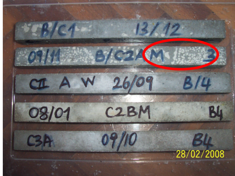
Şekil 5.17 CEM II/A-M(P-W) 42,5R ile hazırlanan, su/çim.=0,7 olan örnekte, deniz suyundaki tuz oranı etkisiyle 111. günde oluşan kabuk atma. Yukarıdan aşağıya sırayla CEM I, CEM II/A-M, CEM II/A-W, CEM II/B-M, CEM III/A çimentoları
