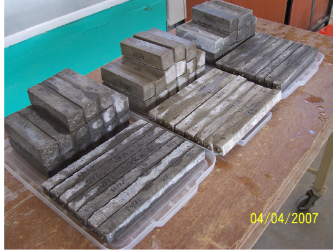
Şekil 4.14 Prizmatik numuneler ve harç çubukları. Soldan sağa SDÇ 32,5, CEM I 42,5 R, CEM IV/B (P) 32,5 N çimento tipleriyle hazırlanan örnekler
