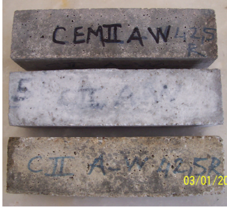
Şekil 5.74 Yukarıdan aşağıya kirece doymun su, ıslanma-kuruma çevrimli deniz suyu ve sodyum sülfat çözeltisinde bekletilen örneklerin görünüm farklılıkları
