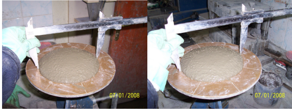
Şekil 4.11 Kumpasla birbirine dik iki doğrultuda yayılma çapı ölçümü (su/çim.=0,7)
