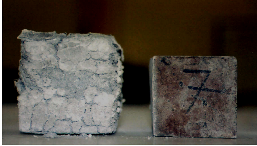
Şekil 2.8 Yüksek oranda alçıtaşı (kalsiyum sülfat) içeren harç örneklerinin havada ve su içinde bekletilmeleri halinde 84 gün sonundaki durumları. Soldaki ağır hasarlı örnek su içinde, sağdaki örnek ise havada bekletilmiştir (Baradan ve diğer.,2002).
