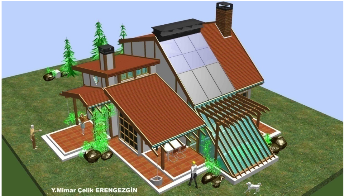
Şekil 4.94 Rüzgar kepçeleri ve venturi bacaları
