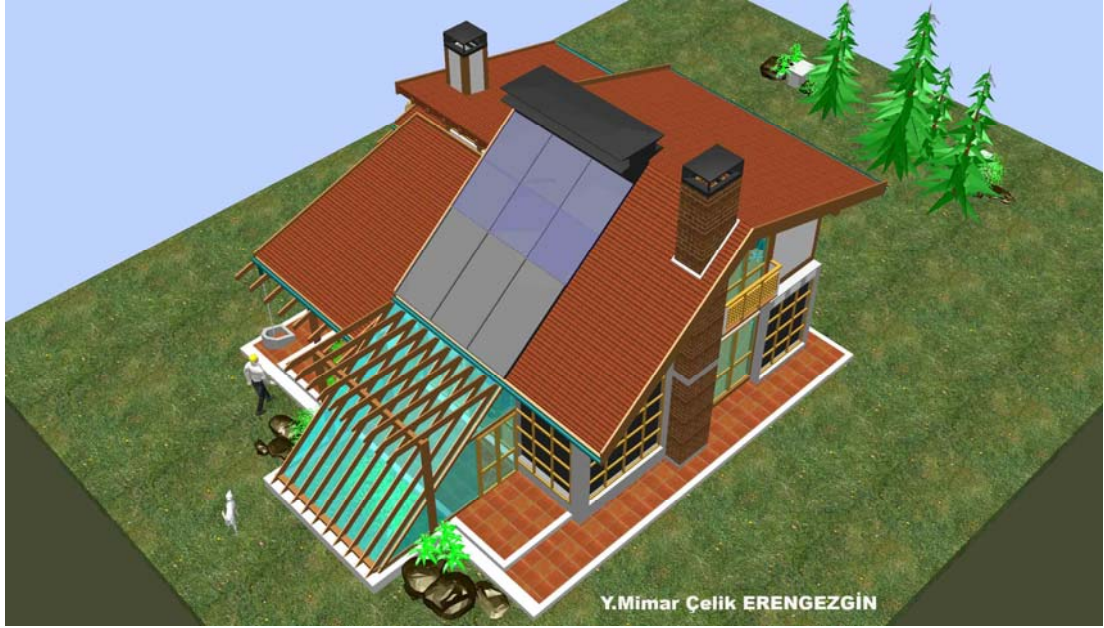
Şekil 4.96 Fotovoltaiklerin tasarım sırasındaki konumlarının gösterimi
