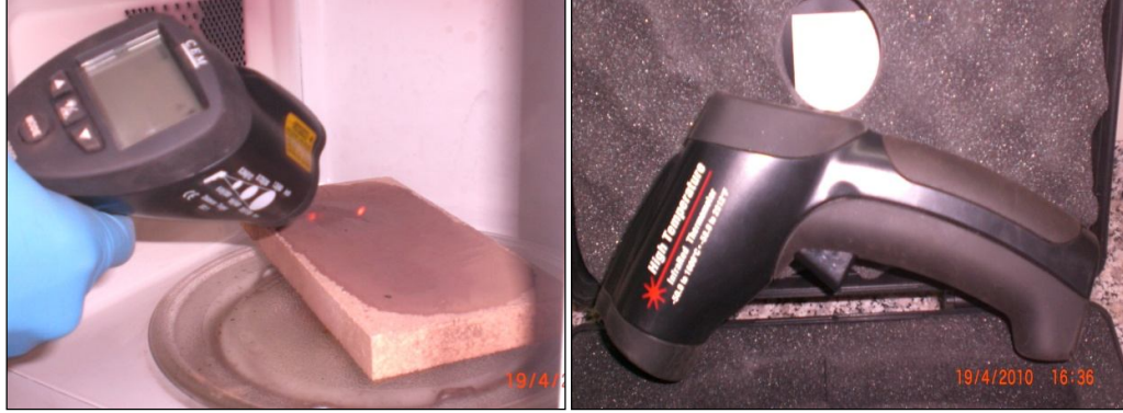
Şekil 7.36 Cem DT 8859 marka infrared termometre ile fırın içindeki numunenin yüzey sıcaklığının ölçülmesi, ölçüm aralığı: -50 + 1600 °C.
