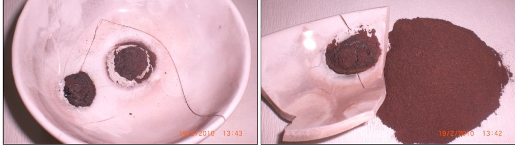
Şekil 7.34 2 Kapsülde yapılan çalışmalarda ani sıcaklık artışları nedeniyle plazma oluşumları.
