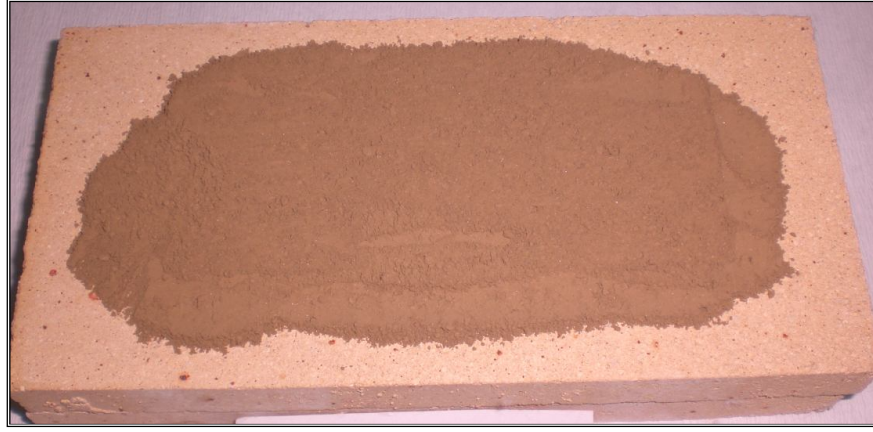
Şekil 7.38 -0,106 mm tane boyutlu cevherin mikrodalga öncesi tuğla üzerine serilmesi.
