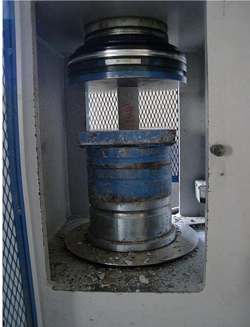
Şekil 2.23 Tek eksenli basma dayanımını belirlemede kullanılan 300 ton basınç verebilme özelliğine sahip pres
