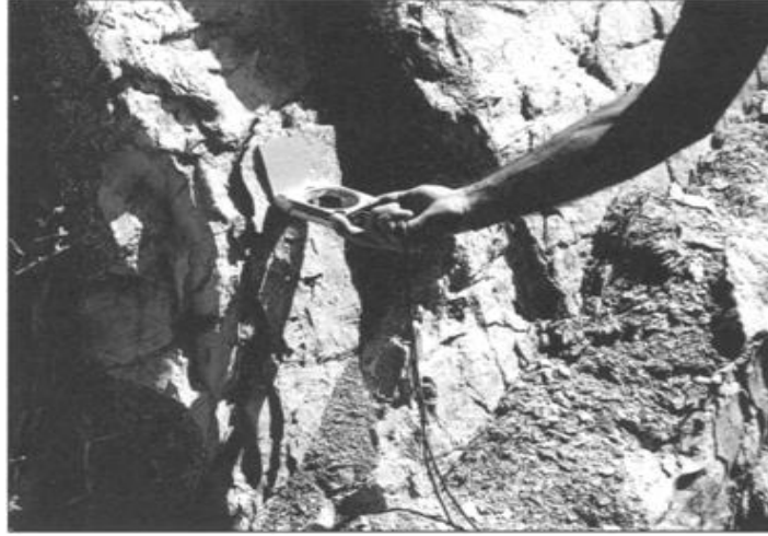
Şekil 2.20 Bir süreksizlik düzleminin yöneliminin pusula ile ölçümü (Ulusay ve Sönmez, 2007).
