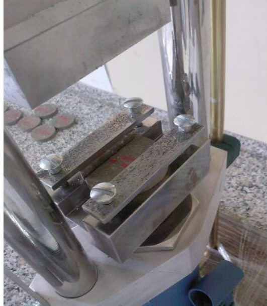
Şekil 2.25 Yüklemeye başlığı, düzenek ve kırılmış numune
