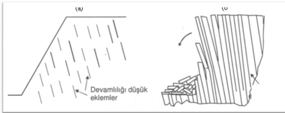
Şekil 2.7 Süreksizliklerin devamlılığının şevlerde duraysızlık modelinin gelişimi üzerindeki etkisine bir örnek: (a) devamlılığı düşük süreksizlikler (devrilme meydana gelmez), (b) yüksek devamlılığa sahip süreksizliklerin neden olduğu devrilme duraysızlığı (Ulusay ve Sönmez, 2007).
