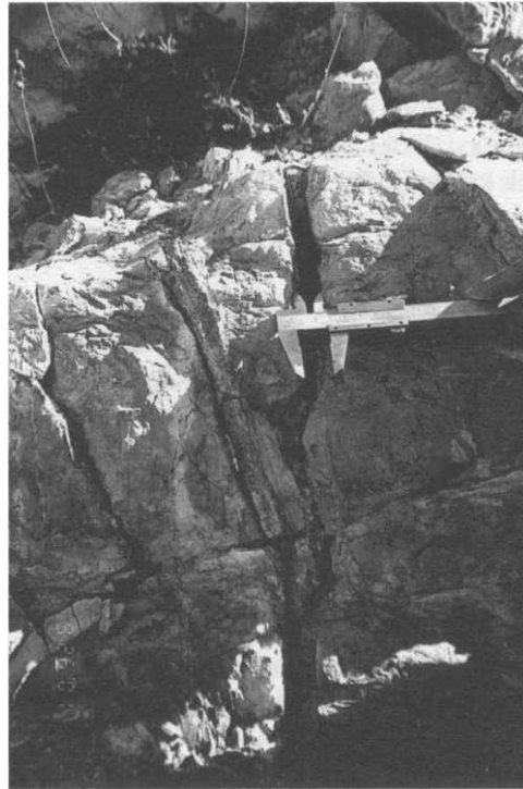
Şekil 2.13 Yumuşak dolgulu bir süreksizlik yüzeyinde mikrometre ile açıklık ölçümü.
