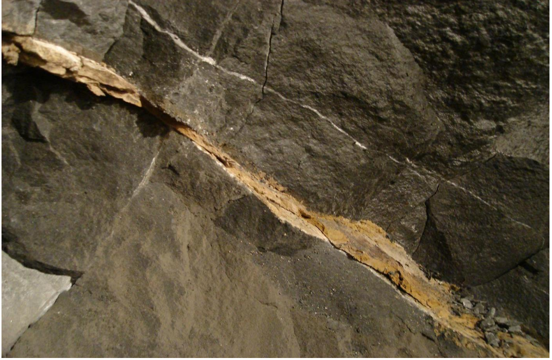
Şekil 2.14 Süreksizlik boşluğunda kil dolgu
