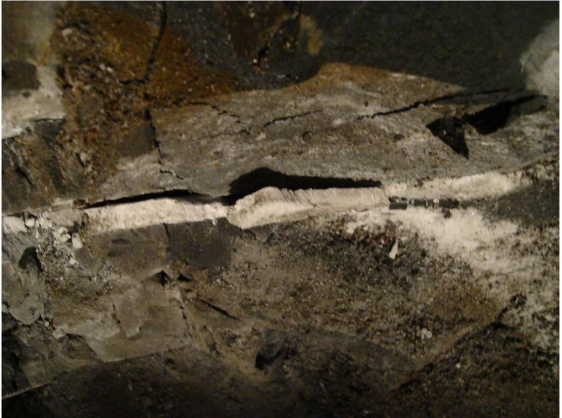
Şekil 2.15 Süreksizlik boşluğunda kuvars dolgu
