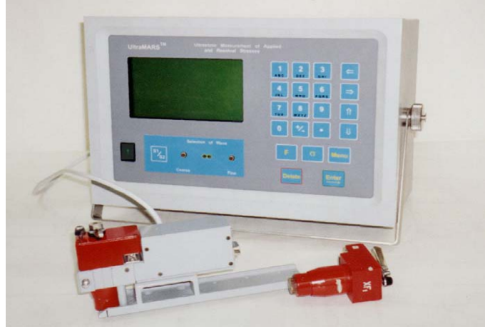
Şekil 2.7 Artık gerilmelerin ultrasonik ölçümleri için geliştirilmiş, sensörlerle donatılmış bir cihaz.
