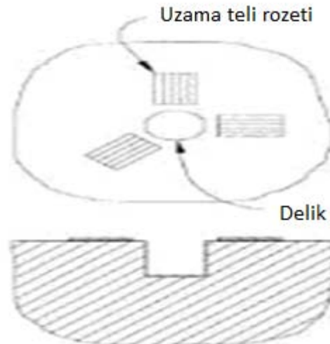
Şekil 2.2 Delik delme yöntemi şematik gösterimi
