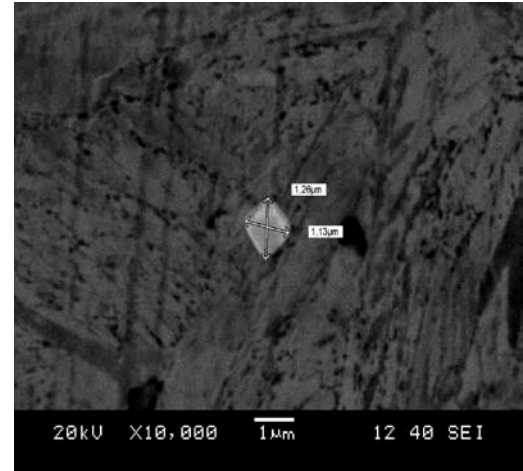
Şekil 6.10 16MnCr5 çeliğinin SEM görüntüleri (a) ısı işleme görmemiş (b) ısı işleme görmüş
