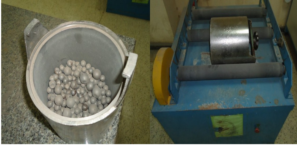
Şekil 4.2 Öğütme deneylerinde kullanılan bilyalı değirmen ve bilyalar
