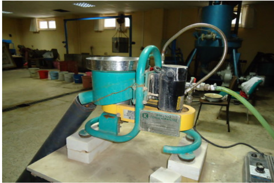
Şekil 4.6 Knelson MD3 model ayırıcı
