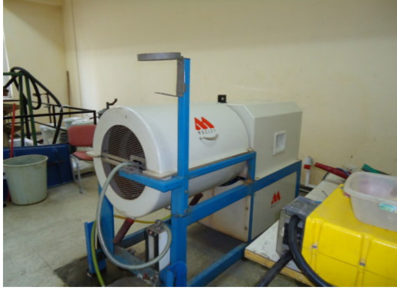
Şekil 4.1 Laboratuvar/Pilot ölçekli MGS(C900)
