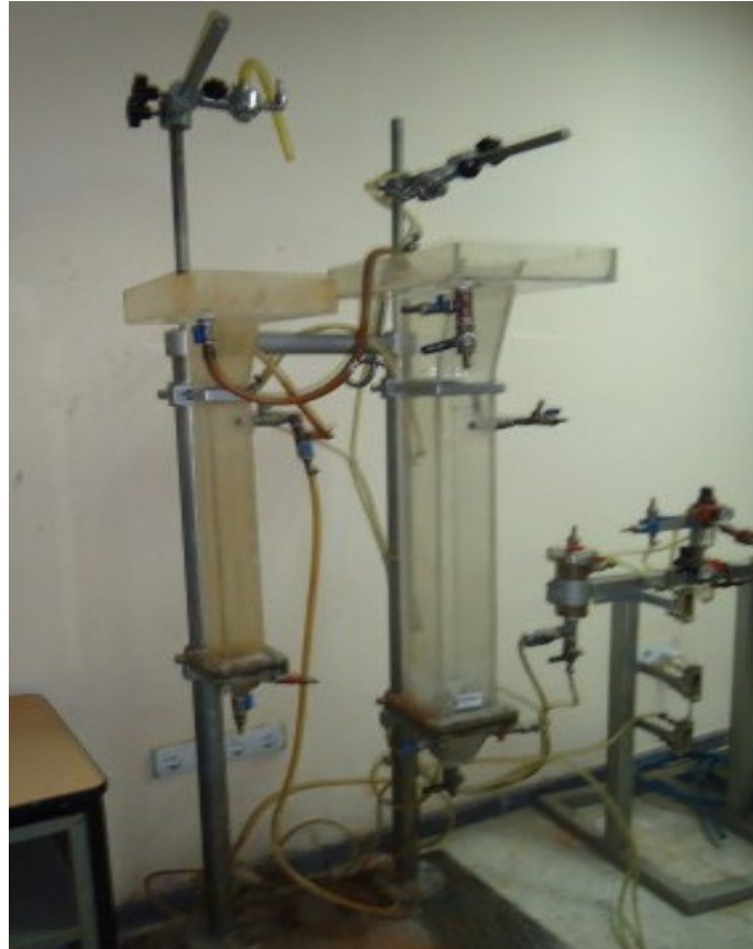
Şekil 4.10 Flotasyon deneylerinde kullanılan kolon flotasyon makinası
