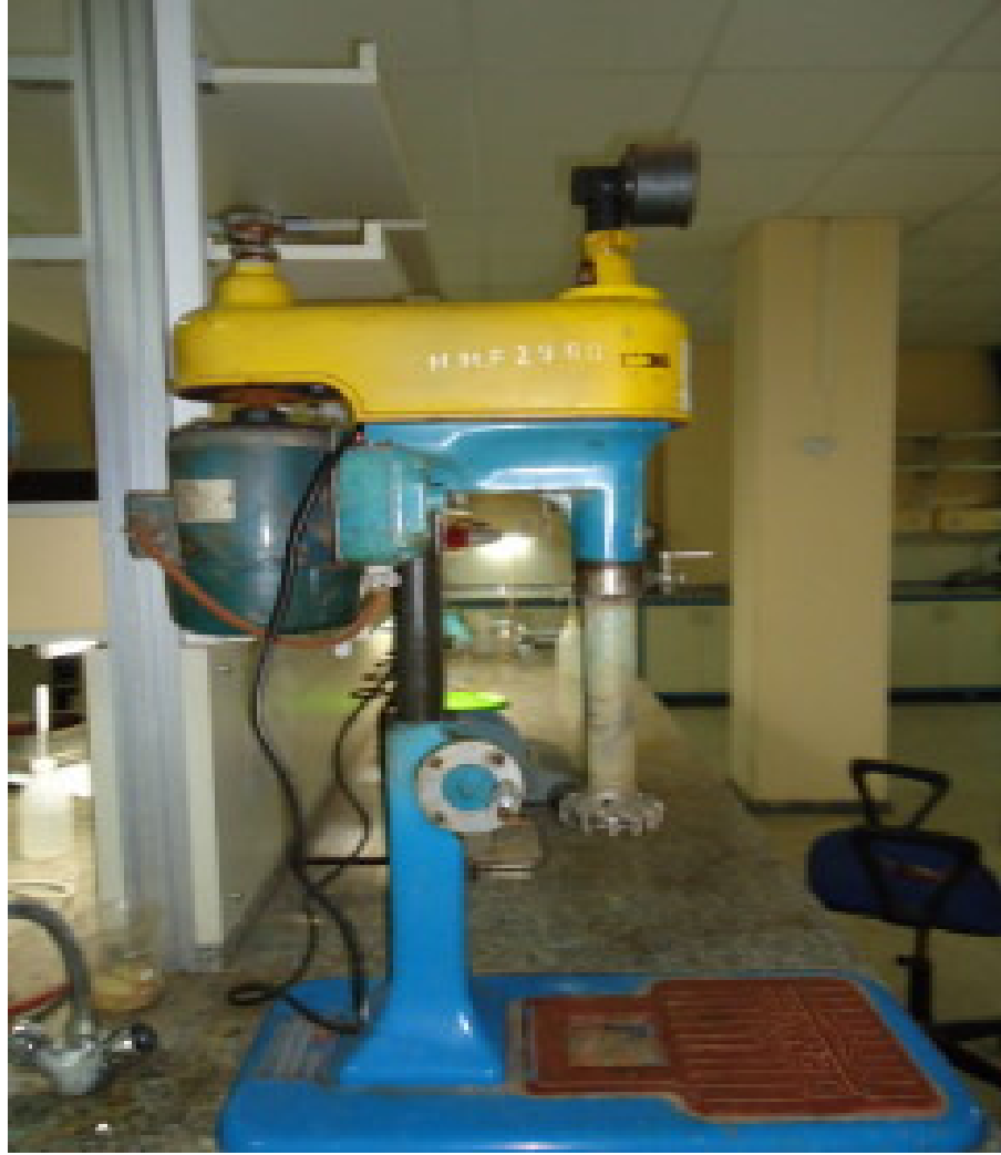
Şekil 4.7 Flotasyon deneylerinde kullanılan Denver D-12 model flotasyon makinesi
