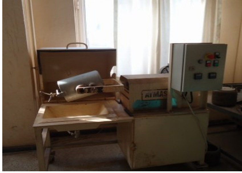
Şekil 4.9 Öğütme deneylerinde kullanılan çubuklu değirmen
