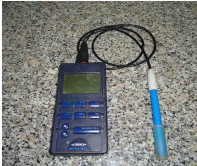
Şekil 4.8 Flotasyon deneylerinde kullanılan WTW marka 340i model pH metre
