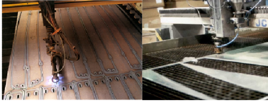
Şekil 3.13 a-F. Gehry, Zollhof Kuleleri, Çelik desteklerin plazma-ark CNC tezgahında kesimi b- ABB Mimarlık BMW Sergi binası, Alüminyum su jeti CNC tezgahta kesimi (Kolarevic, 2003)
