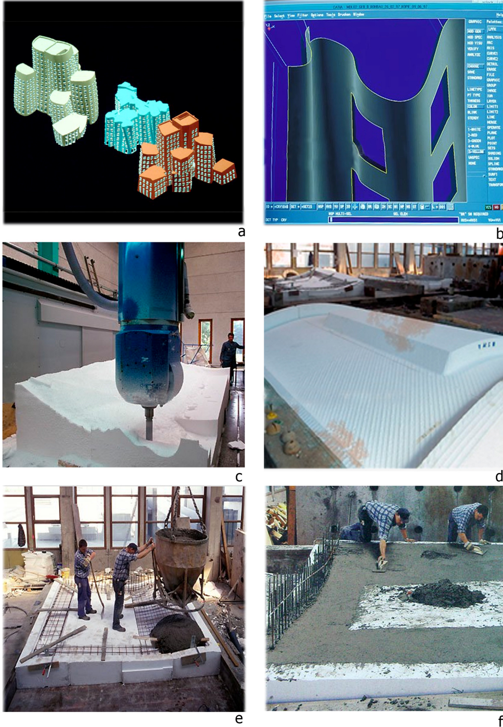
Şekil 3.16 Zollhof yapı bloğunun ürün geliştirme ve üretim süreci, ( http://thomasmayerarchive.de )
