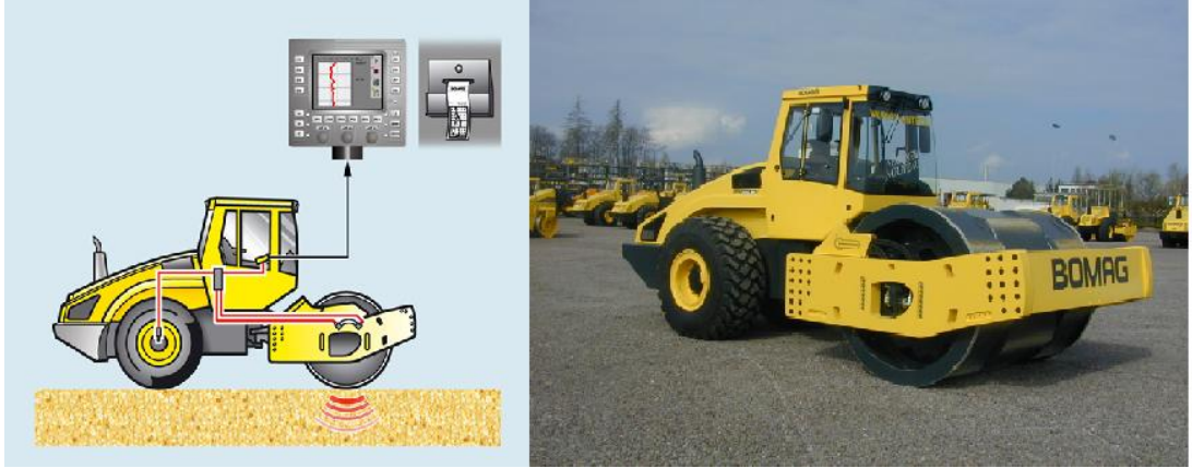
Şekil 4.14 Sıkıştırma işlemi ve zemine etkisi.
