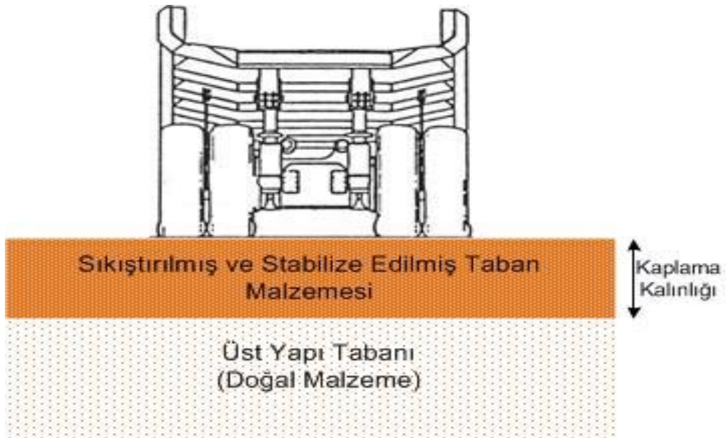
Şekil 3. 2 Stabilize Kaplama En Kesiti
