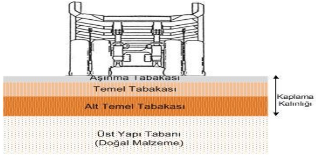
Şekil 3. 1 Esnek Yol Kaplama En Kesiti
