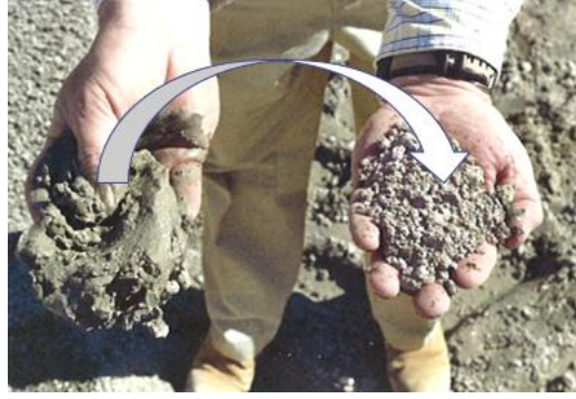
Şekil 4.3 İyon alış verişinden sonra zemin daneli yapıya dönüşür.
