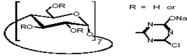
Şekil 1.17 Monoklortriazin-β-siklodekstrinin moleküler yapısı (Wacker- Chemie GmbH)
