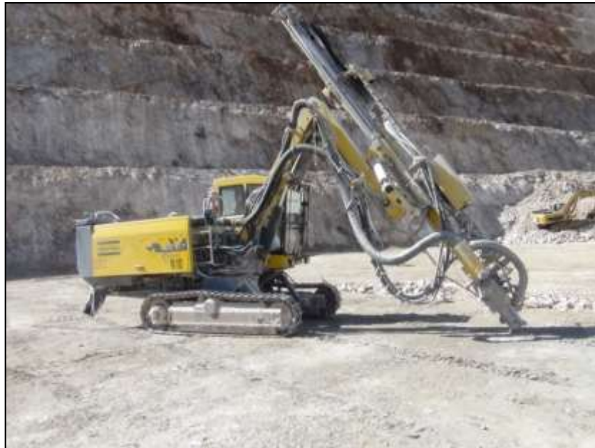
Şekil 3.9 Sahada kullanılan delici makina.
