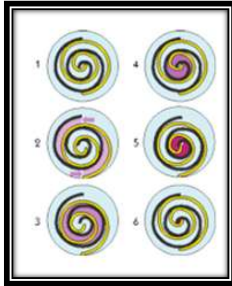
Şekil 2.4 Scroll tip kompresör çalışma prensibi
