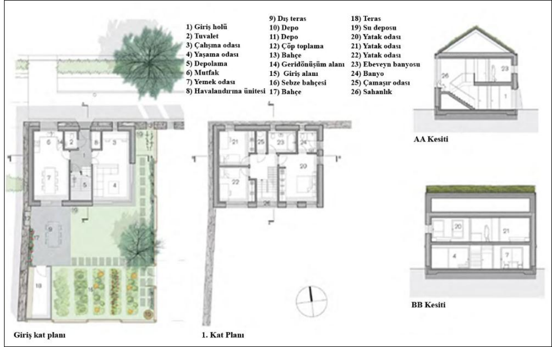
Şekil 4.63 The Larch House plan ve kesitleri (Denby Dale Passivhaus, bt)
