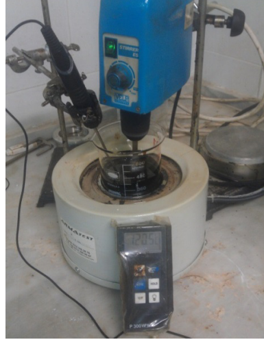
Şekil 5.6 IKA katkıli bitümlerin ısıtıcı kullanılarak üretilmesi
