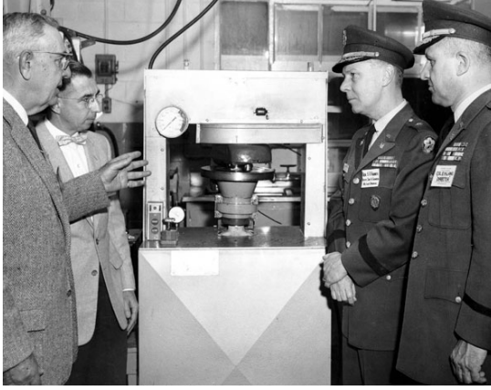
řekil 3.4 Teksas Karayolları tarafından imal edilen ilk yoęurmalı pres (www.fhwa.dot.gov, 2014)
