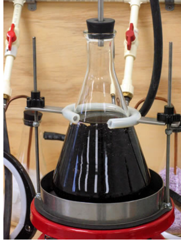
Şekil 3.2 Karışımın maksimum özgül ağırlığının belirlenmesi
