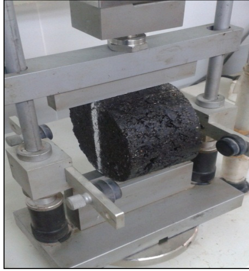
Şekil 5.10 Numunenin indirekt çekme mukavemeti ölçümü için cihaza yerleştirilmesi
