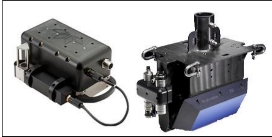
Şekil 3.7 OdomMB1ekosounder ve Kongsberg Geoswath Ekosounder (Anonim - e, b. t)
