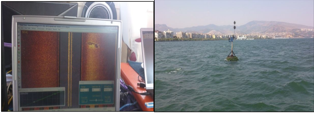
Şekil 3.11 Sonar kaydında görülen anomali aslında sıhık şamandıranın tonozu
