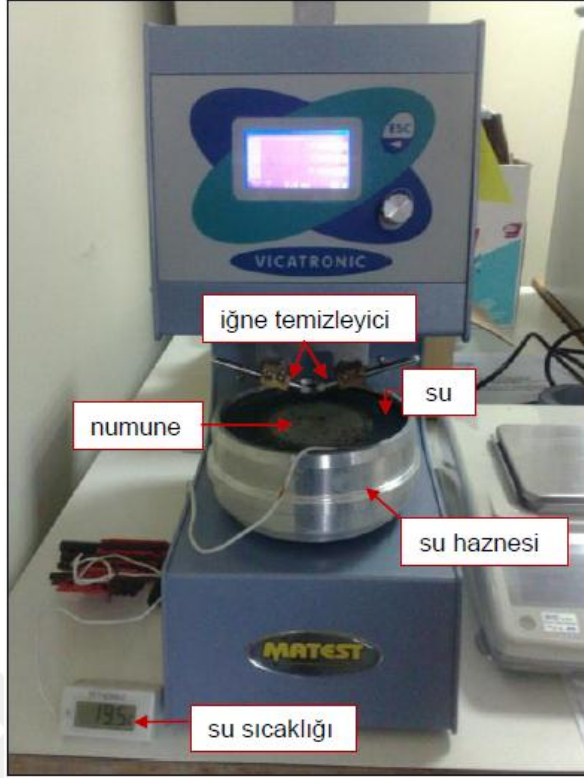
Şekil 6.4 Otomatik Vicat cihazı ile priz sürelerinin tayini
