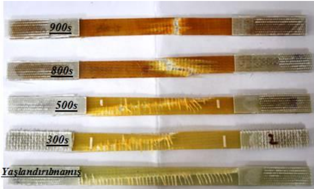
Şekil 4.4 Farklı yaşlandırma süreleri sonunda çekme testi yapılmış fiber yönündeki numuneler
