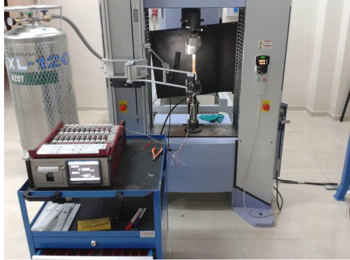
Şekil 2.9 Poisson oranının bulunması için hazırlanmış test düzeneği
