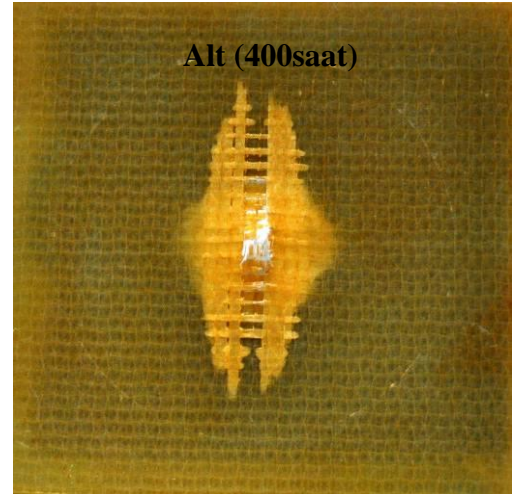
Şekil 4.24 60 Joule darbe enerjisine maruz kalmış 0, 100 ve 400 saat yaşlandırılmış numuneler
