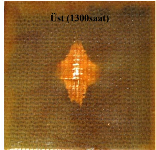
Şekil 4.23 40 Joule darbe enerjisine maruz kalmış 700, 1000 ve 1300 saat yaşlandırılmış numuneler
