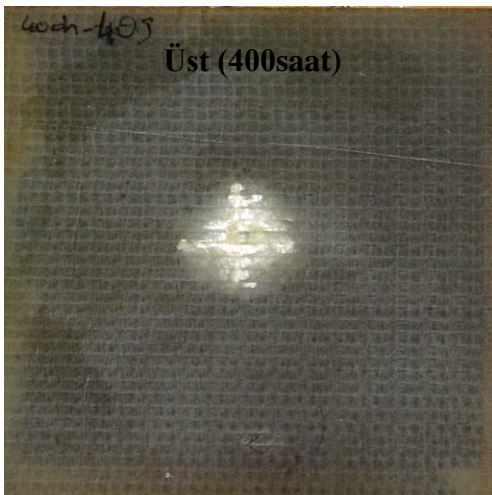
Şekil 4.22 40 Joule darbe enerjisine maruz kalmış 0, 100 ve 400 saat yaşlandırılmış numuneler
