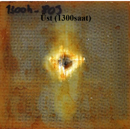
Şekil 4.27 80 Joule darbe enerjisine maruz kalmış 700, 1000ve 1300 saat yaşlandırılmış numuneler
