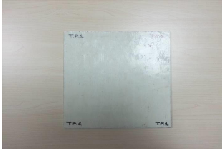
Şekil 2.6 Termoplastik reineli e-cam takviyeli kompozit
