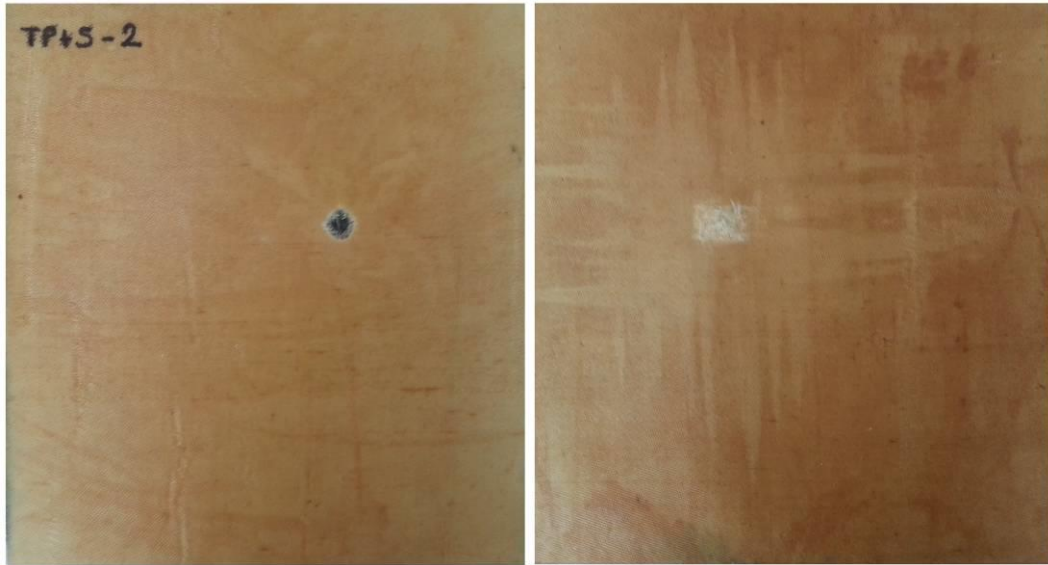
Şekil 3.33 Birinci tip hibrid kompozit plakada darbe sonrası ön ve arka kısımlarda oluşan deformasyon
