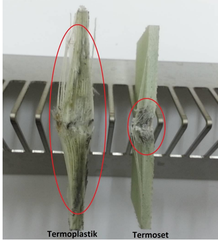
Şekil 3.26 Termoplastik ve termoset reçineli kompozitlerin tekrarlı darbe sonrası kesit görünüşleri
