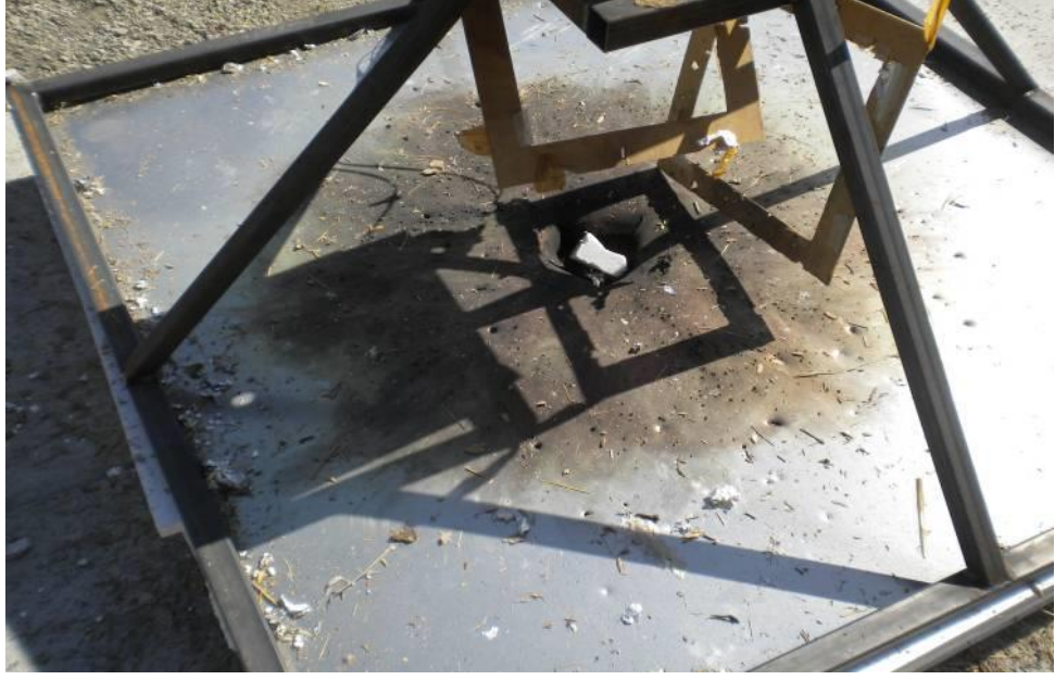
Şekil 3.2 RHA Testi - Darbe sonrası saçılma etkisi
