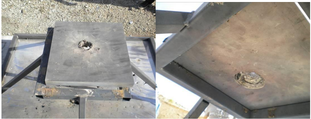
Şekil 3.3 Alüminyum plaka ön ve arka yüzeylerindeki deformasyon.
