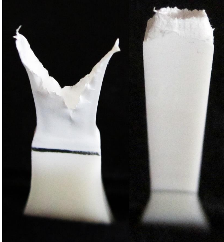
Şekil 7.5 %20 talk dolgulu polipropilen çekme numunesinin çekme testi sonrası kopma yüzeyleri
