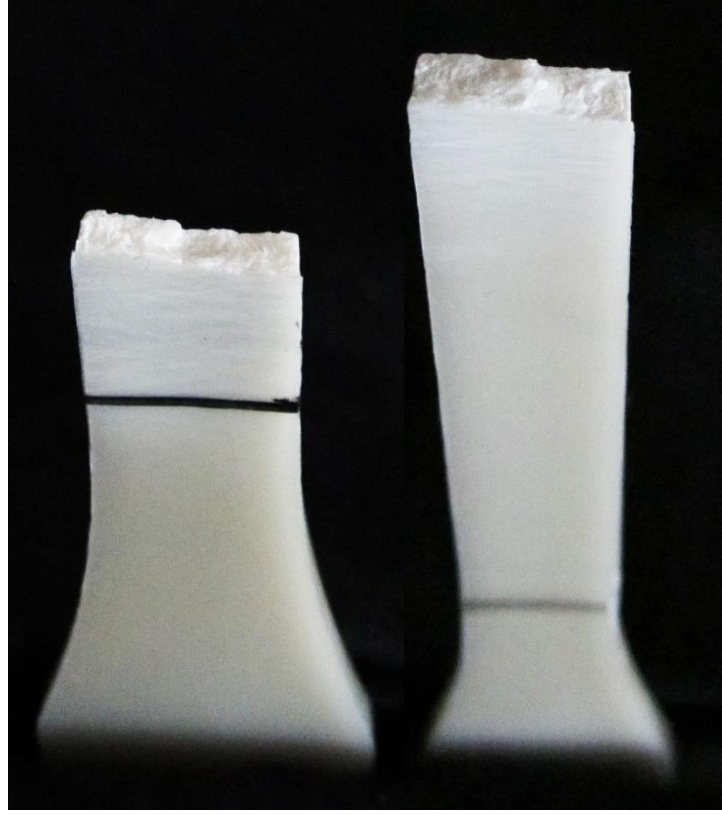
Şekil 7.6 %40 talk dolgulu polipropilen çekme numunesinin çekme testi sonrası kopma yüzeyleri
