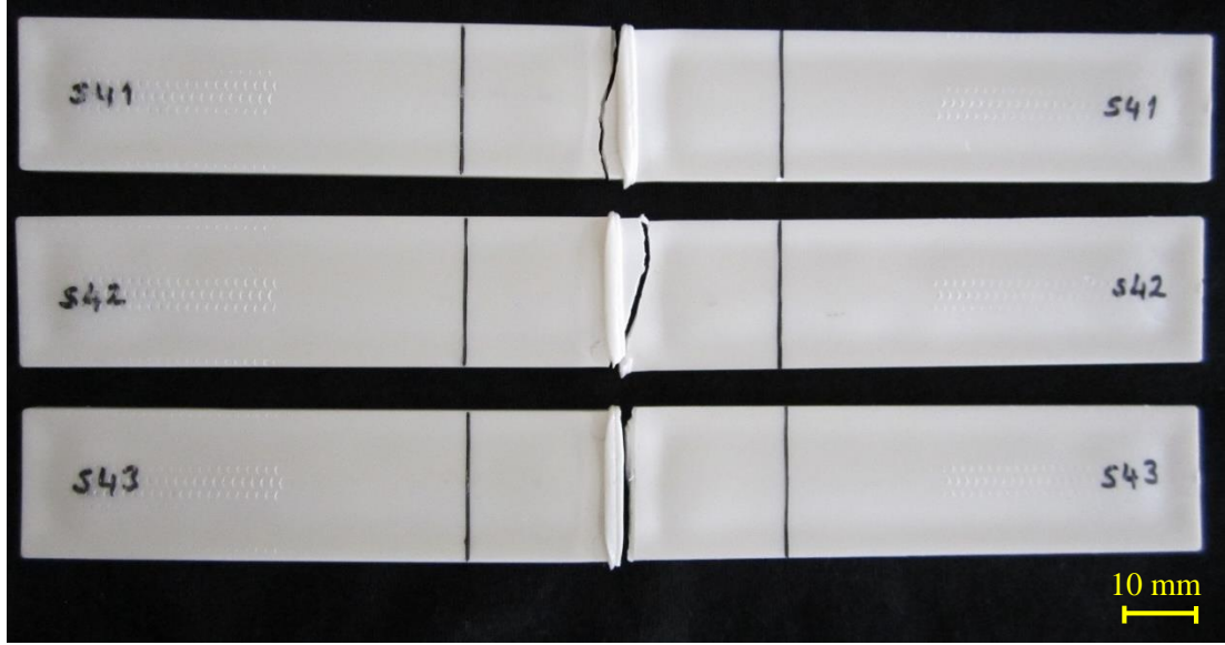
Şekil 7.23 Optimum kaynak parametreleriyle kaynatılan %40 kalsit dolgulu polipropilen numuneleri
