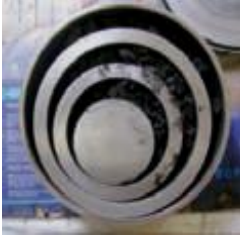
Şekil 2.15 Klasik halkalı değirmen ve silindirli Micros Mic-O değirmeni (Hacıfazlıođlu , 2009)
