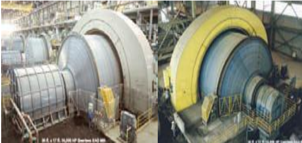
Şekil 2.9 Yarı otojen (SAG Mill) değirmenin görüntüsü (Hacıfazlıoğlu, 2009)
