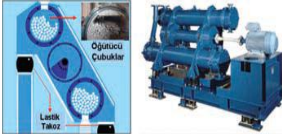
Şekil 2.13 Titreşimli değirmen ve kesit görüntüsü (Yıldız, 2007)
