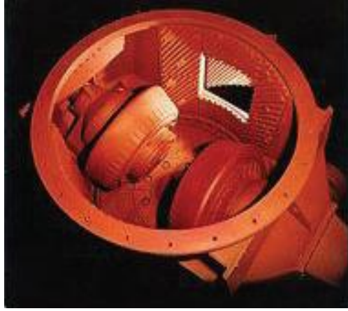
Şekil 2.10 Valsli değirmenin çalışma prensibi ve ruloların görüntüsü (Pilevneli 2003)
