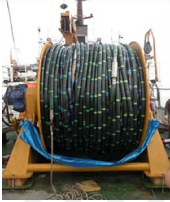
Şekil 3.6 TAMAM projesi kapsamında kullanılan sismik alıcı kablo (streamer).
