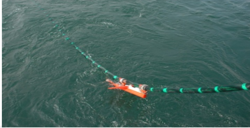
Şekil 3.8 TAMAM projesi kapsamında kullanılan derinlik düzenleyici (bird).
