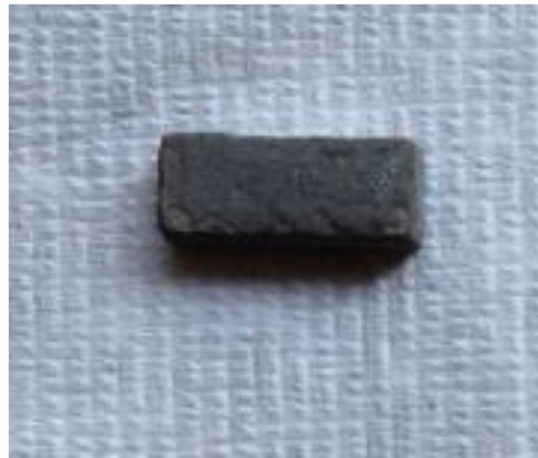
Şekil 4.5 Silisyumlanmış AISI 1040 numunesi.
