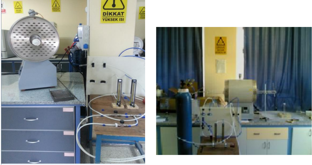
Şekil 3.3 Önoksitleme deneylerinin yapıldığı düzenek.
