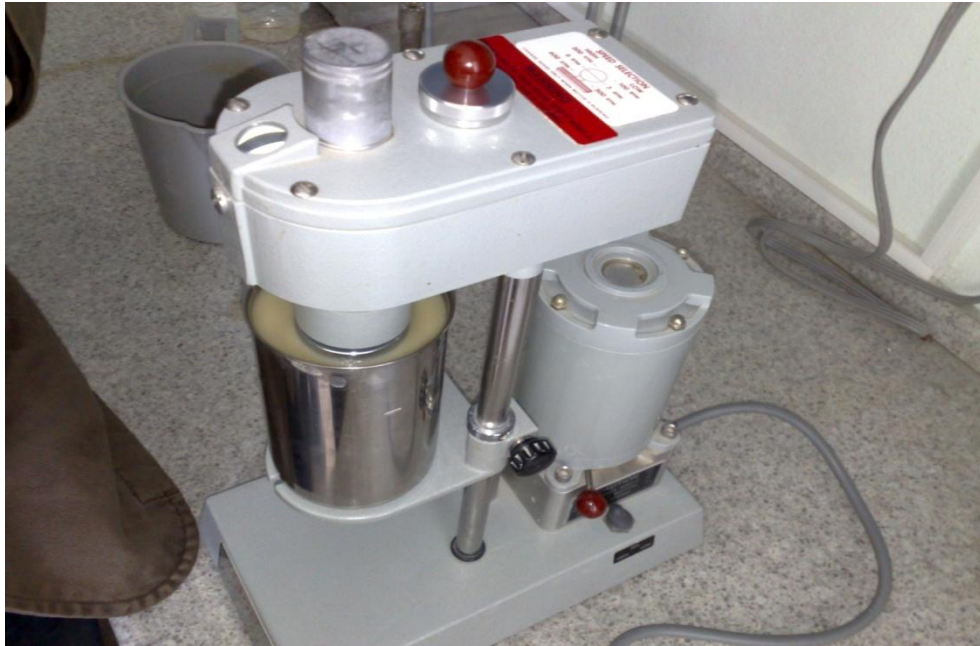
Şekil 4.2 Reoloji ölçümleri için kullanılan Fann Viskozimetre cihazı
