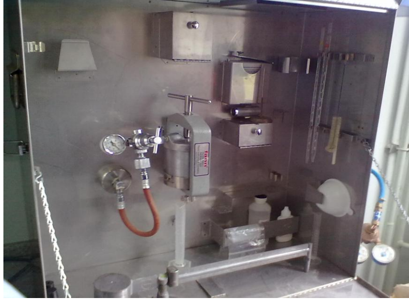
Şekil 4.4 Süzöntü hacmi deney düzeneği
