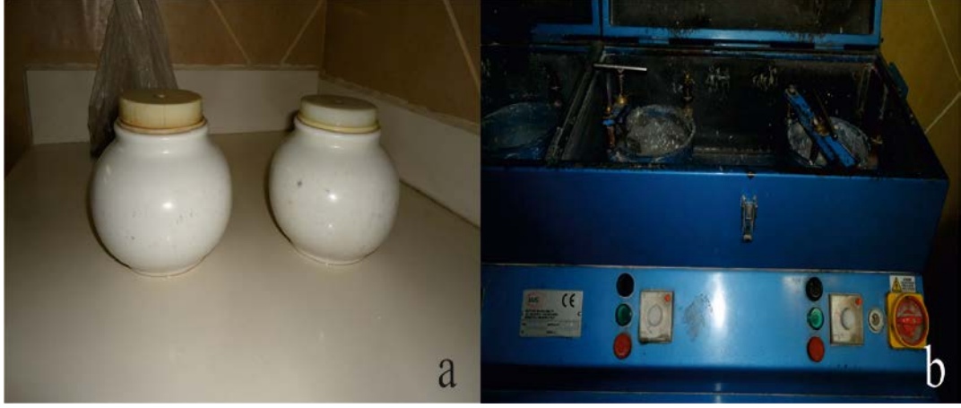
Şekil 3.5 Porselen kavanozlar (a) ve jet değirmen (b).
