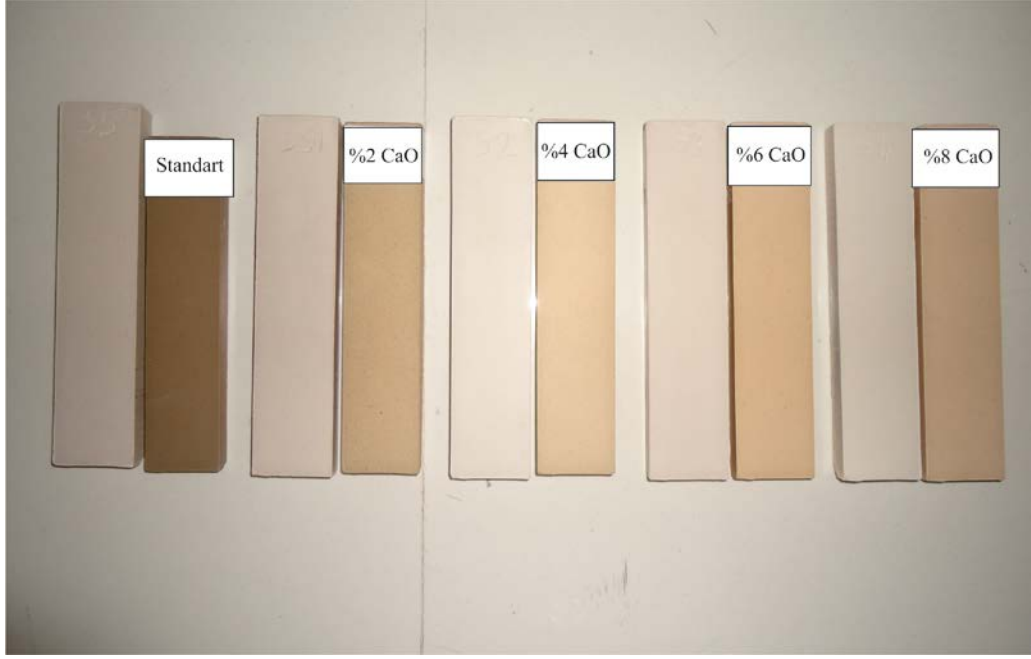
Şekil 3.7 Pişirme öncesinde ve sonrasında duvar karoları (sol: pişmemiş, sağ: pişmiş).
