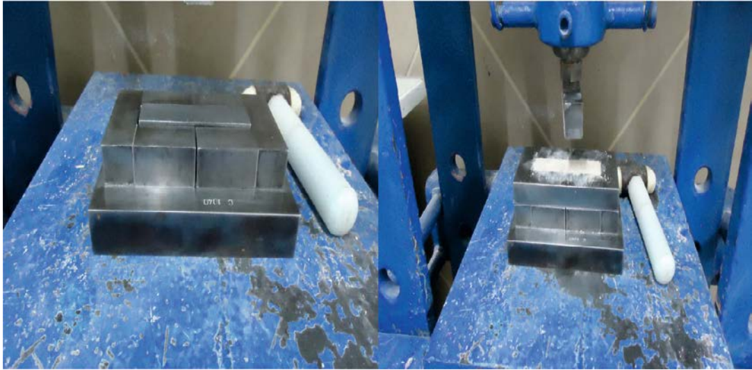
Şekil 3.6 Hidrolik pres kalıbı ve malzemenin preslenmesi.
