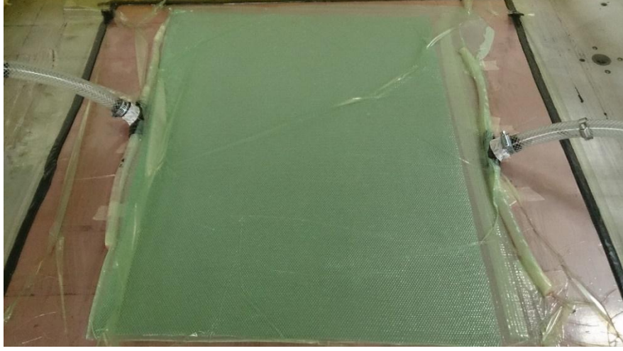
Şekil 6.5 Vakum destekli reçine infüzyon sistemi ile üretim
