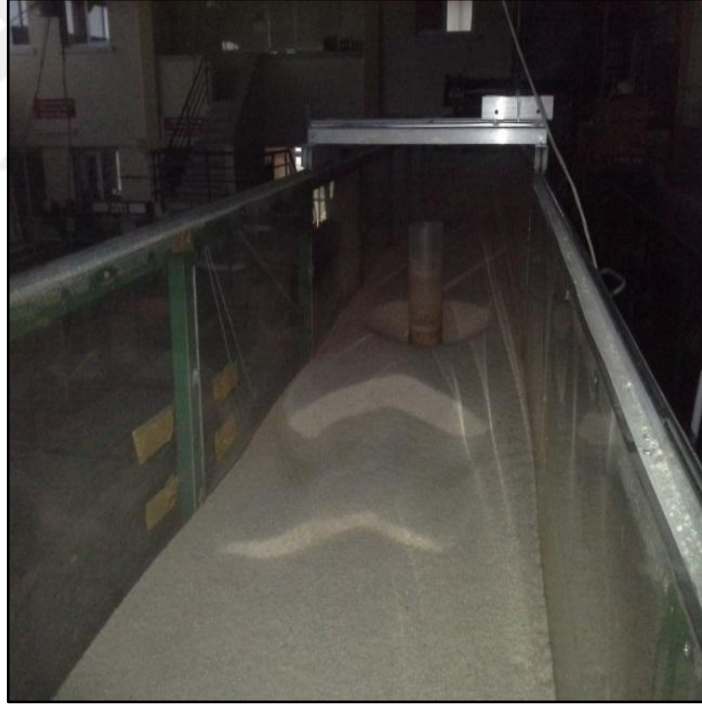
Şekil 16 D-15-5 nolu deney sonrasında elde edilen eşyüksekti eğrisi ve çekilen fotoğraf
