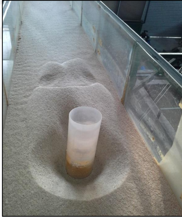
Şekil 15 D-15-4 nolu deney sonrasında elde edilen eşyükselti eğrisi ve çekilen fotoğraf
