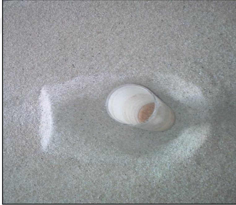
Şekil 2 D-8-2 nolu deney sonrasında elde edilen eşyükselti eğrisi ve çekilen fotoğraf
