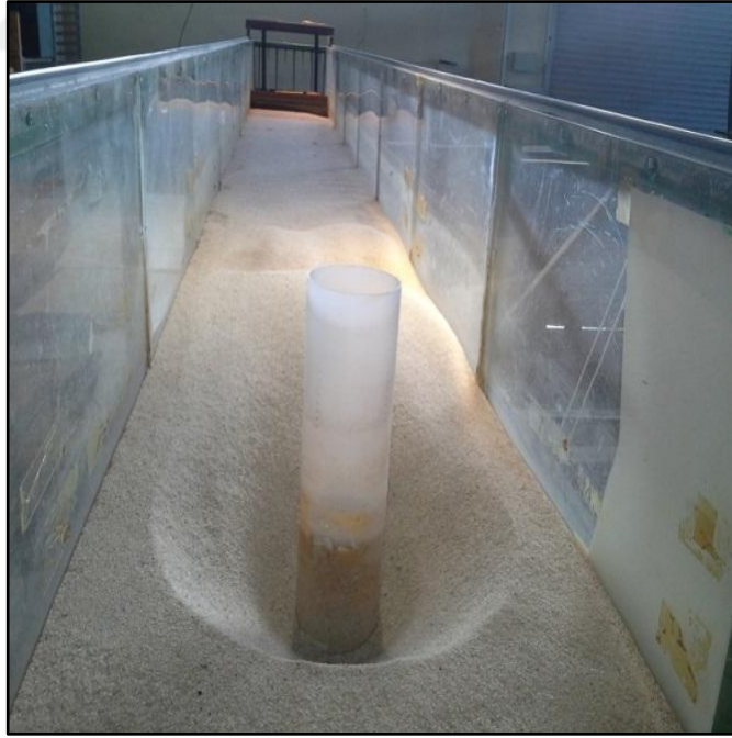
Şekil 17 D-15-6 nolu deney sonrasında elde edilen eşyüksekti eğrisi ve çekilen fotoğraf
