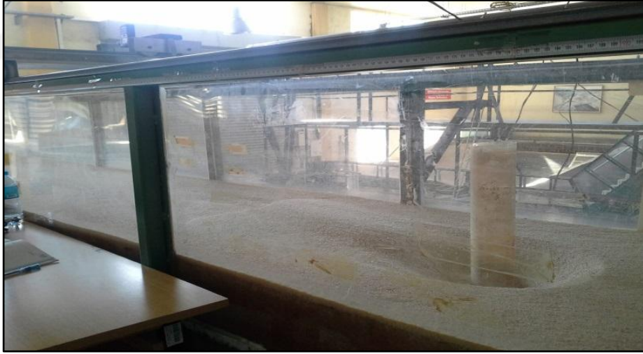
Şekil 6 D-8-7 nolu deney sonrasında elde edilen eşyüksekti eğrisi ve çekilen fotoğraf
