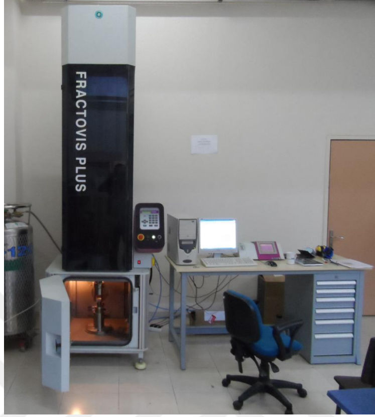
Şekil 4.19 CEAST Fractovis Plus darbe cihazı
