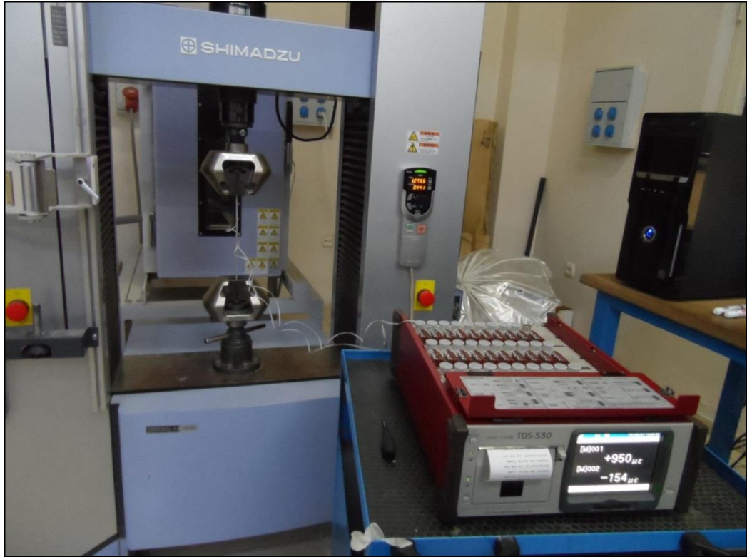
Şekil 4.4 Datalogger veri cihazı ve Poisson Oranlarının ölçülmesi deneyi düzeneği
