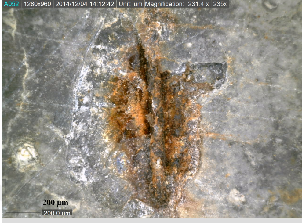
Şekil 7.31 IK etkisinden kaynaklanan yüzey lifinin korozyonu sebebiyle gelişen matris hasarı.
