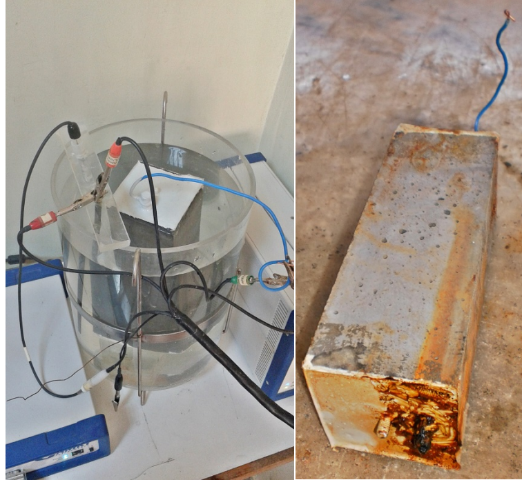
Şekil 6.25 Yetersiz epoksi kaplaması yapılan çelik donatıda gelişen korozyon.
