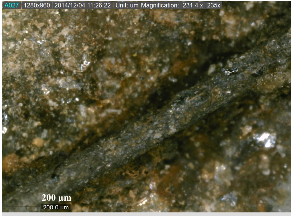
Şekil 7.30 IK etkisiyle yüzeyde korozyona uğramış bir lifin yuvası.
