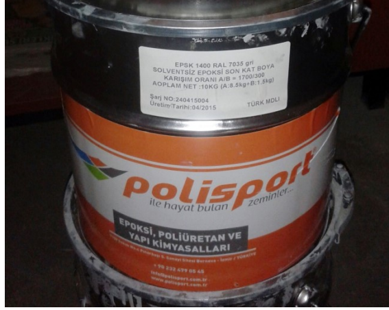
Şekil 4.2 Donatı korumada kullanılan solventsiz epoksi malzemesi.
