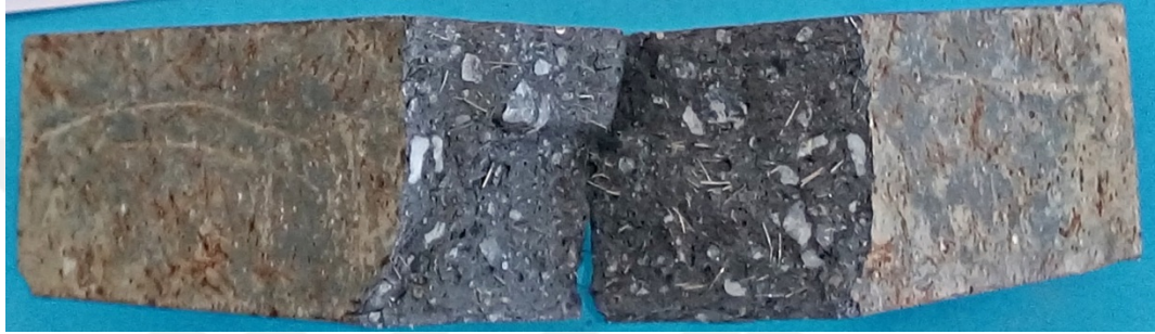
Şekil 7.33 500 IK çevrimi sonrası UK30-İ50-F2 karışımındaki liflerin yüzey durumu.
