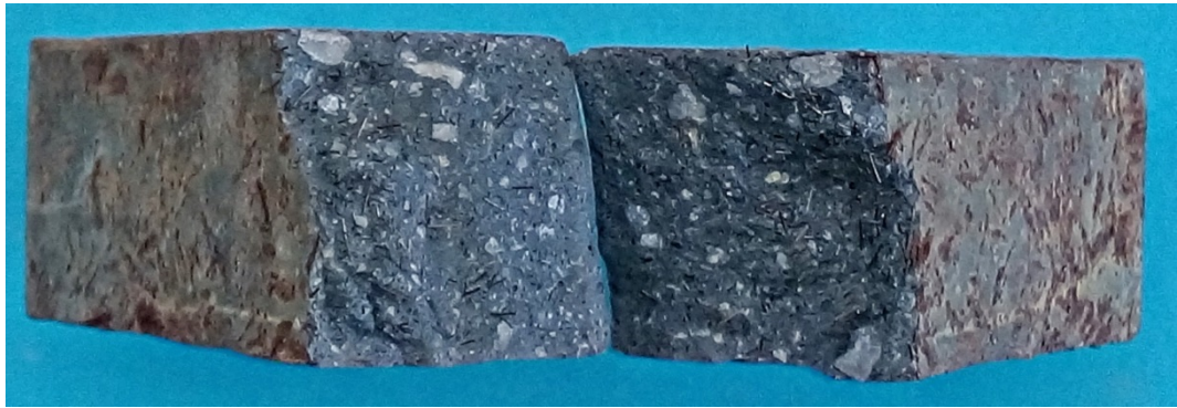
Şekil 7.34 500 IK çevrimi sonrası YFC50-İ50-F2 karışımındaki liflerin yüzey durumu.
