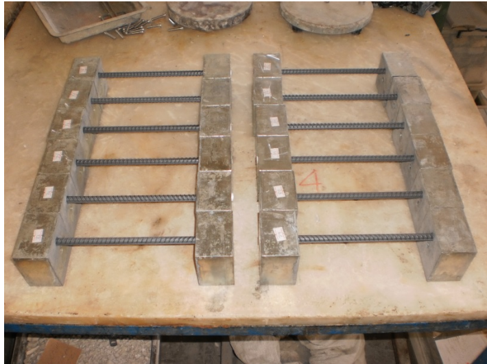
Şekil 6.14 Donatıların tartılarak kodlanması.
