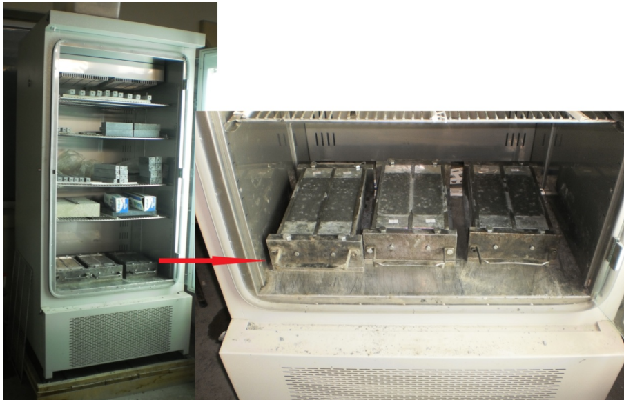
Şekil 6.21 Taze karışımların iklimlendirme kabinine yerleştirilmesi (Kuruma Koşulu= 30\pm 1^{\circ}\text{C} , \%50\pm 2 bağıl nem).
