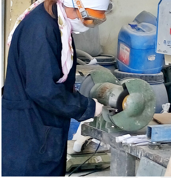
Şekil 6.30 Döner çelik fırça kullanılarak donatı korozyonunun temizlenmesi.
