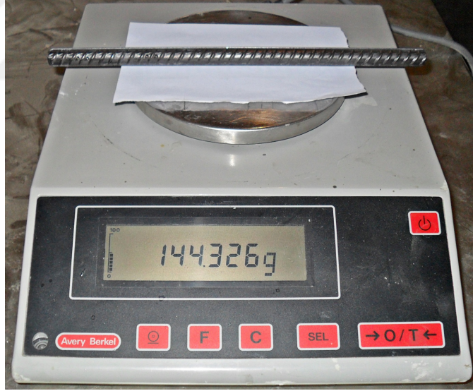
Şekil 6.31 Hassas Terazi ile donatıda kütle kaybı ölçümü.
