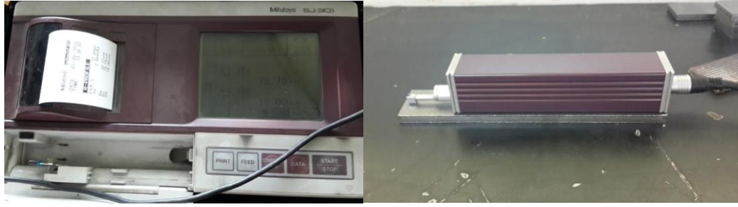
Şekil 2.8 Numunelerin yüzey pürüzlülüğü Mitutoyo SJ-301 cihazı ile yapılmıştır
