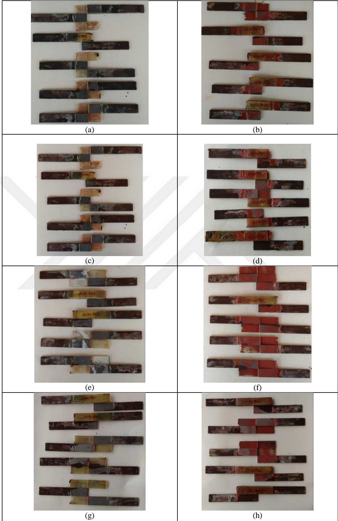
Şekil 3.16 İki ay yaşlandırılmış çift karşılıklı bağlantı elemanı numunelerinin çekme testi sonrası hasar görünümleri
