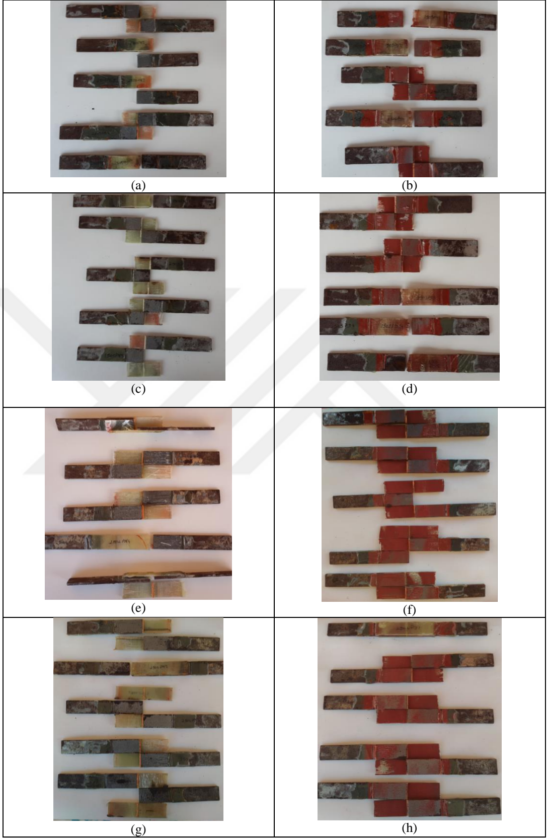
Şekil 3.14 Bir ay yaşlandırılmış çift karşılıklı bağlantı elemanı numunelerin çekme testi sonrası hasarlanmaları
