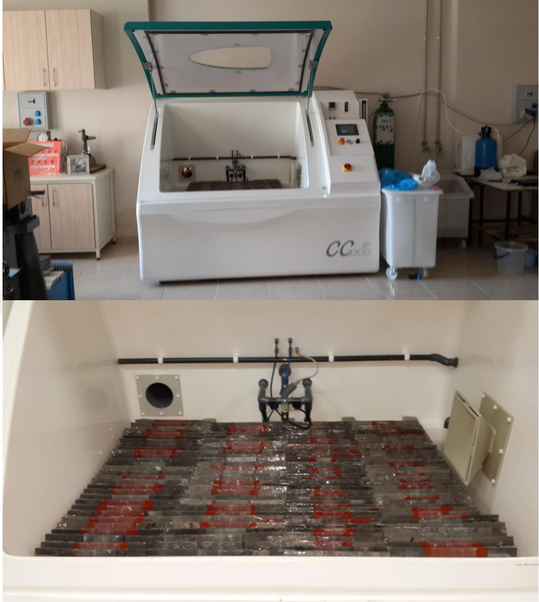
Şekil 2.20 Tuz sisi ve çevrimsel korozyon test kabini ve raflarına dizilmiş numuneler
