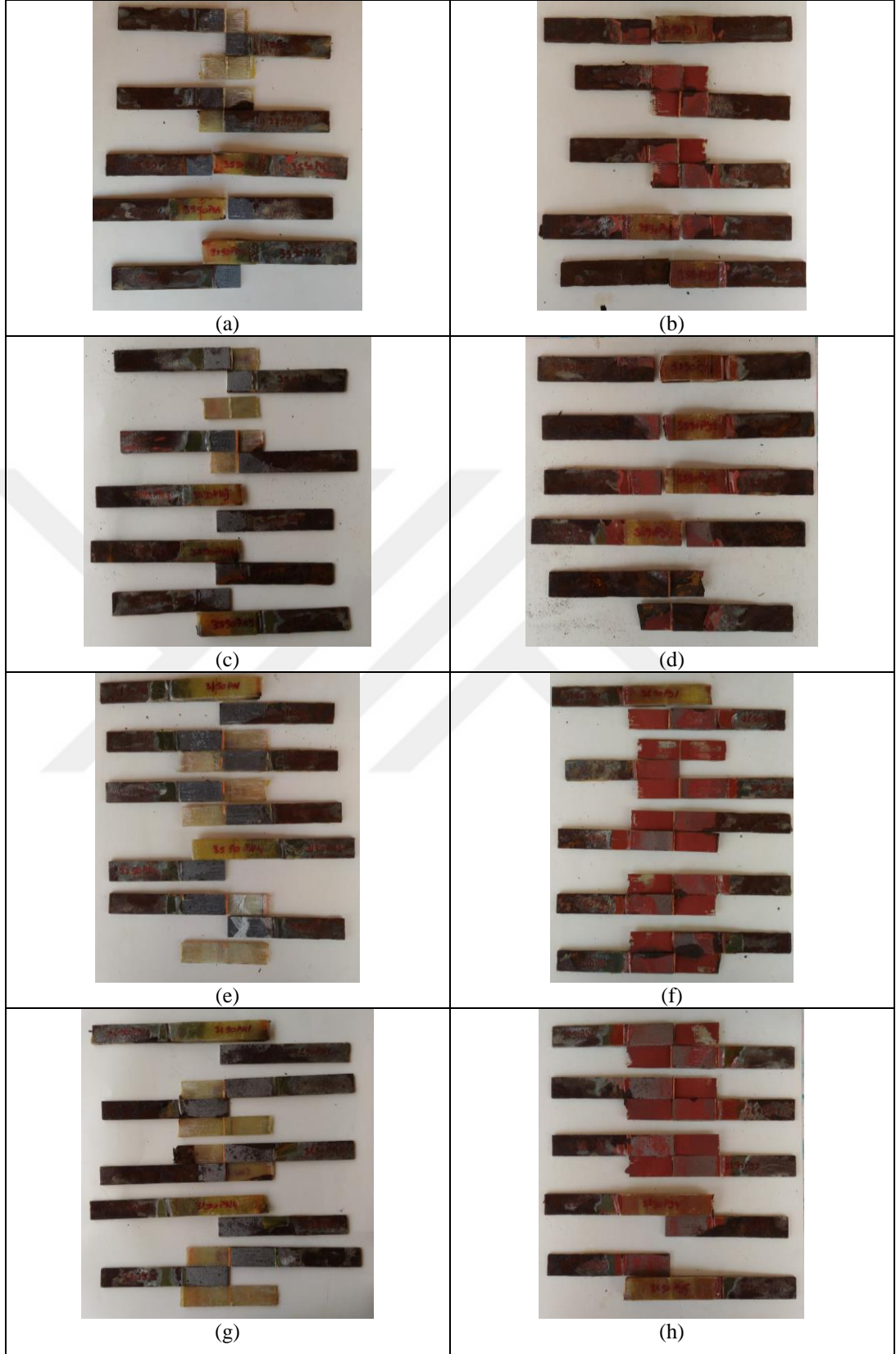
Şekil 3.19 Üç ay yaşlandırılmış çift karşılıklı bağlantı elemanı numunelerin çekme testi sonrası hasarlanmaları
