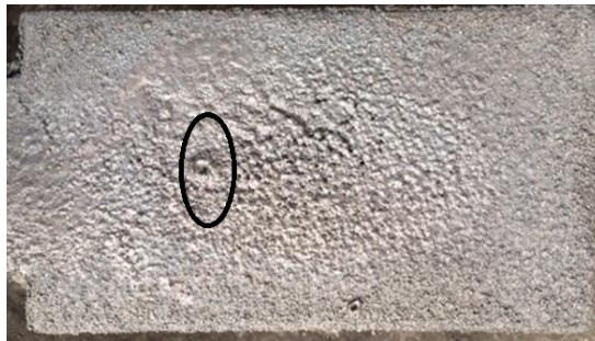
Şekil 5.52 Orta ekzotermik özellikli besleyici gömlek kullanılarak dökülen ASTM-A128M-93A alaşımli parçanın kumlama sonrası görüntüsü
