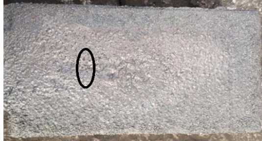
Şekil 5.51 Yüksek ekzotermik özellikli besleyici gömlek kullanılarak dökülen ASTM-A128M-93A alaşımli parçanın kumlama sonrası görüntüsü
