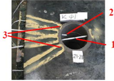
Şekil 3.15 Termal çiftlerin yerleştirilmesi (Ignaszak ve diğer., 2005)
