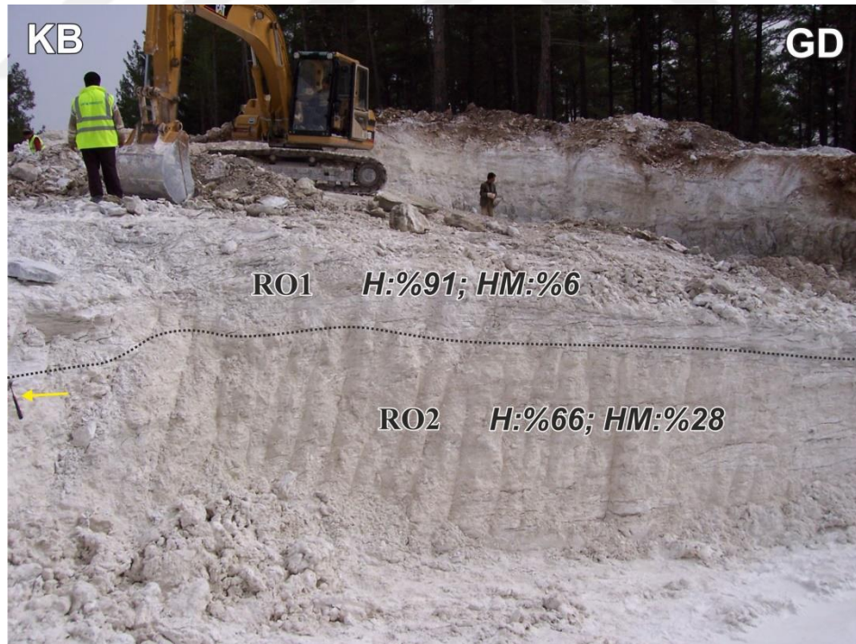
Şekil 3.4 RO1 ve RO2 örneklerinin alındığı L2 altbiriminin huntit-hidromanyezit ocağı içindeki görünümü (H: huntit, HM: hidromanyezit).
