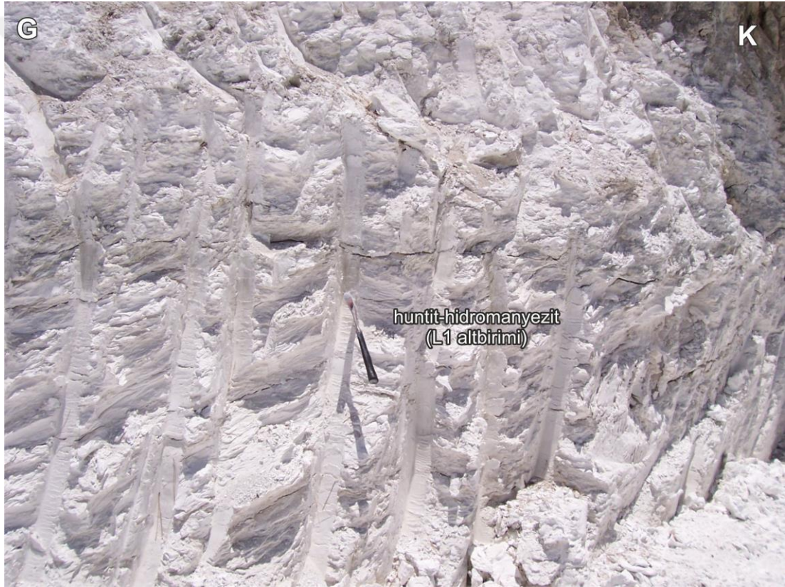
Şekil 2.22 L1 altbirimi içerisindeki huntit mineralinin baskın olduęu seviyeler.
