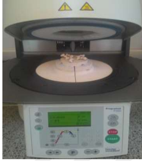
Şekil 3.3 Numunelerin fırınlanma rejimi için kullanılan vakum fırını (Kişisel arşiv, 2015)
