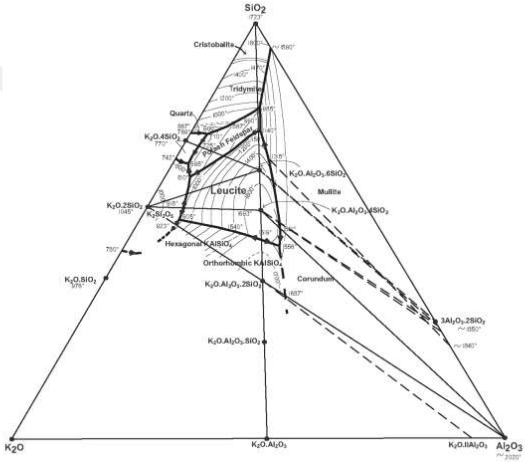
Şekil 2.8 K_2O-Al_2O_3-SiO_2 üçlü faz sistemi (Mrazova, 2009)
