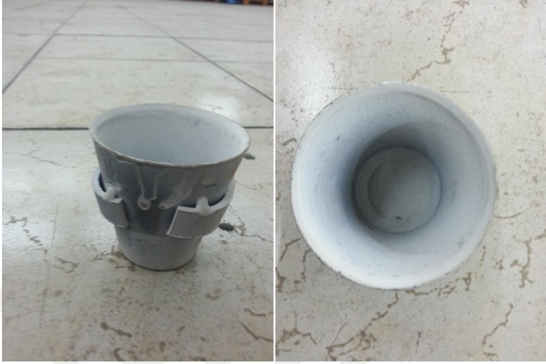
Şekil 3.3 Bifilm incelemeleri için kullanılan RPT numune kalıbı
