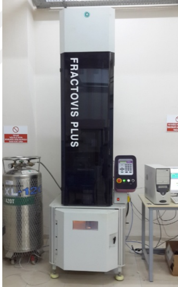
Şekil 4.11 CEAST-Fractovis Plus darbe cihazı
