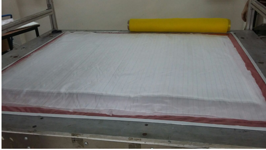
Şekil 3.10 Kumaşlar üzerine soyma kumaşı ve ayırıcı filmin serilmesi
