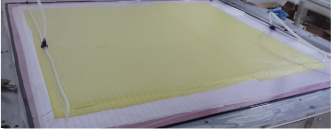
Şekil 3.12 Vakum torbasının sızdırmazlık macunlarıyla yapıştırılması
