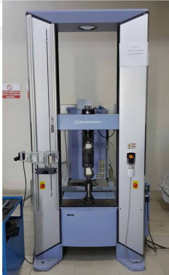
Şekil 4.1 Shimadzu AG-X çekme testi cihazı
