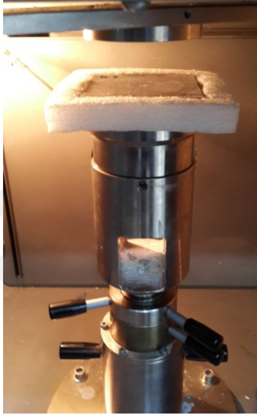
Şekil 4.12 CEAST-Fractovis Plus darbe cihazı numune sıkma aparatı
