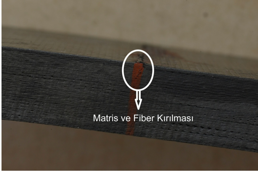
Şekil 4.20 Cb 6 numunesinde yorulma testi sonrası oluşan hasarlar.
