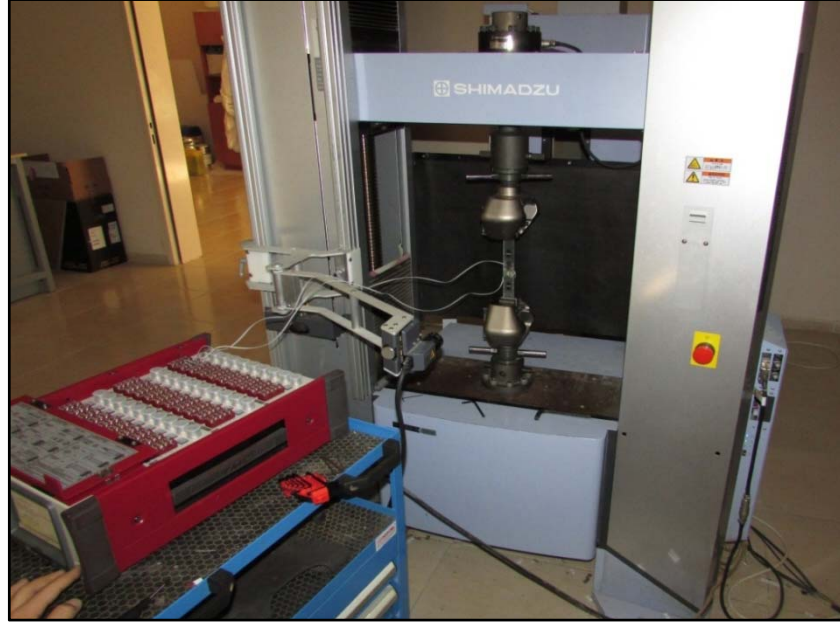
Şekil 3.8 Çekme testinden bir görüntü.
