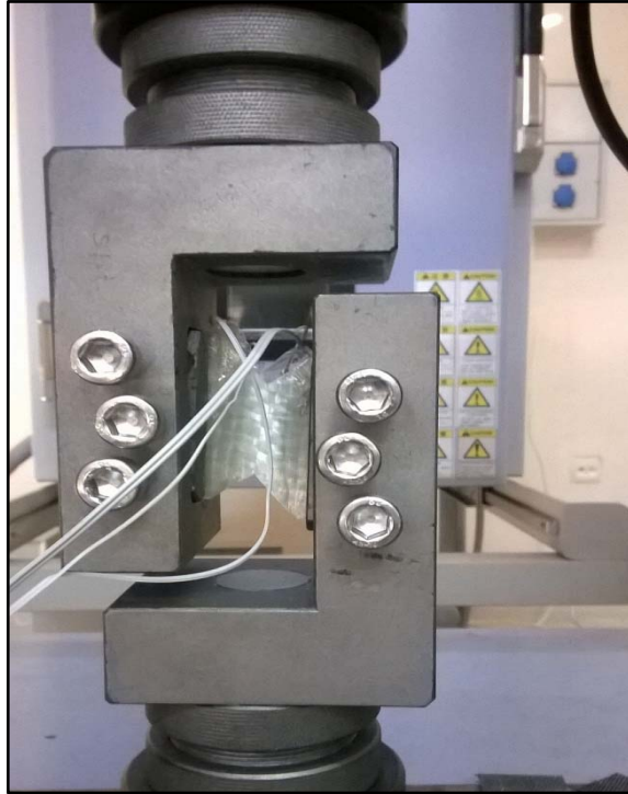
Şekil 3.9 V-çentikli kesme testinden bir görüntü.
