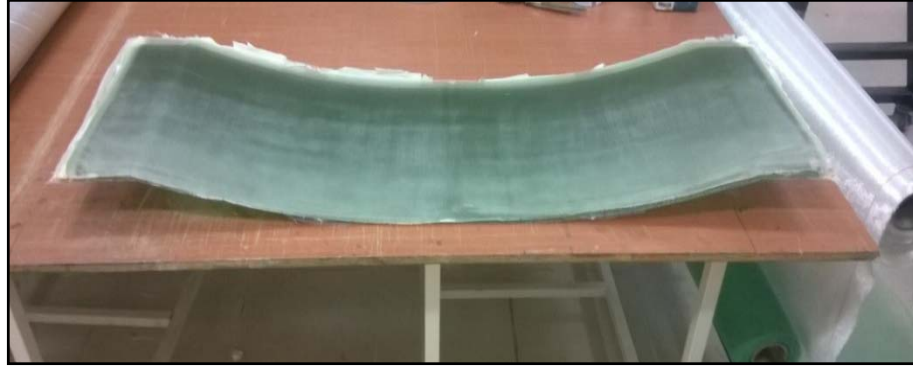
Şekil 3.5 Üretim sonrası düz uçlu E-camı/epoksi kompozit yaprak yaylar.
